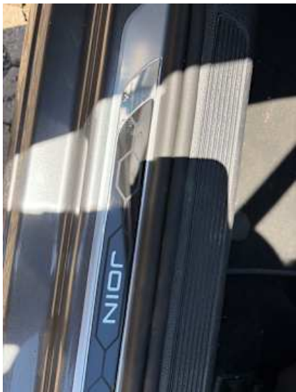
Schweller links (Kratzer)
