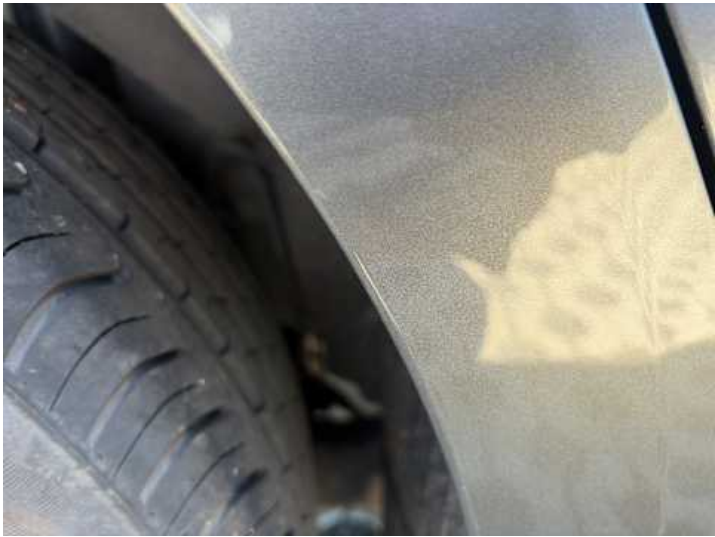
Seitenteil hinten rechts (Kratzer)
