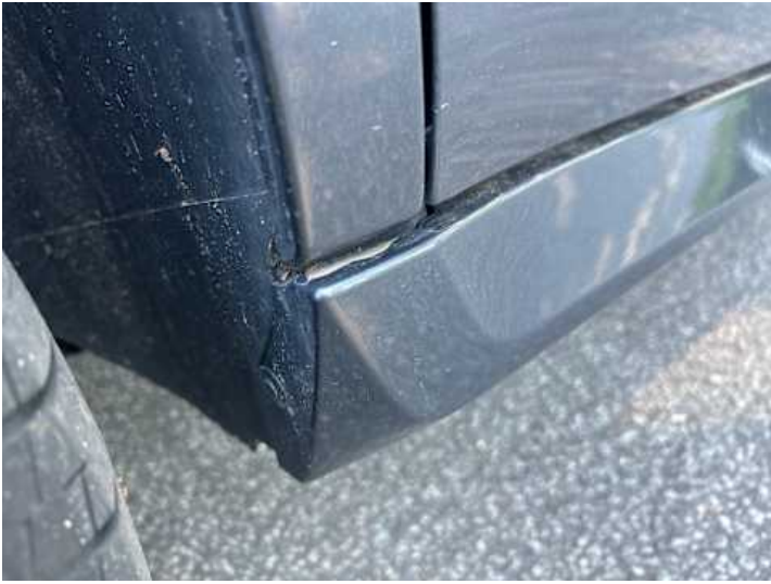
Schweller rechts (Lackschaden)
