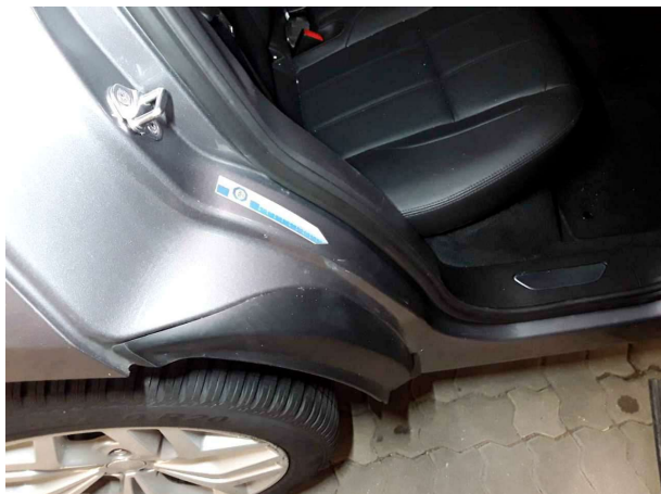
Beschädigung #1: Seitenwand rechts: Einstieg - Kratzer - Smart Repair
