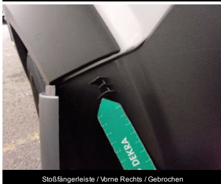
Stoßfängerleiste / Vorne Rechts / Gebrochen
