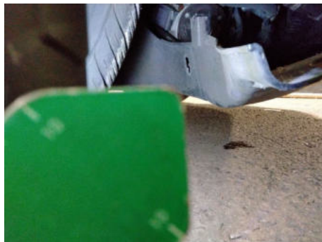
Unterfahrschutz / Vorne / Gebrochen
