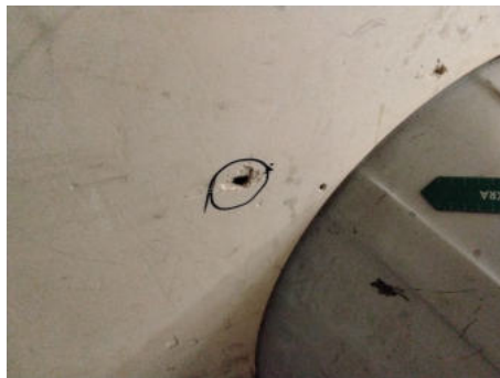
Innenverkleidung Laderaum / Rechts / Defekt
