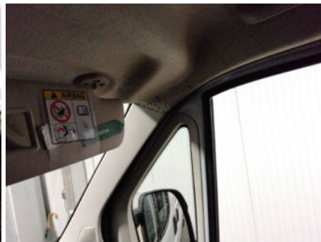
Dachhimmel / Vorne / Fleck
