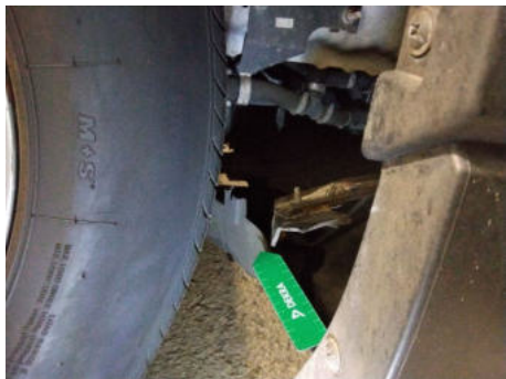
Unterfahrschutz / Vorne / Gebrochen
