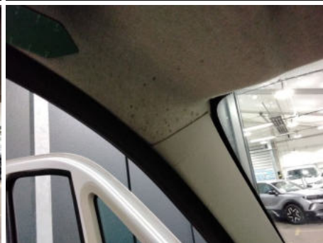
Dachhimmel / Vorne / Fleck
