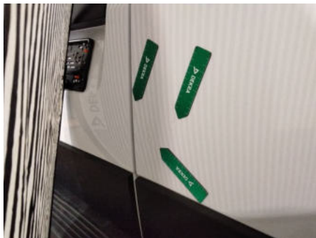
Heckklappe / Kofferraumtür / Hinten Rechts / Delle
