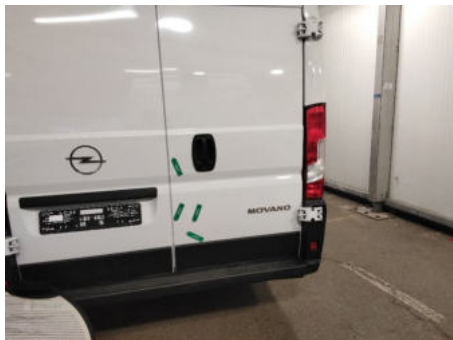
Heckklappe / Kofferraumtür / Hinten Rechts / Delle
