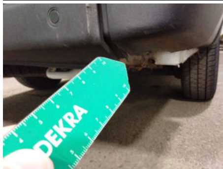
Stoßfänger / Hinten Rechts / Gebrochen
