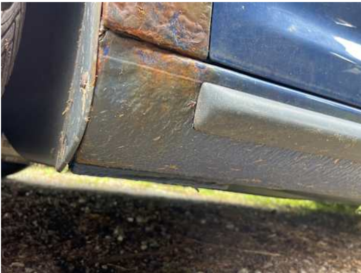
Schweller links (Rost, Lackschaden)
