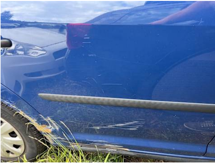
Türe hinten rechts (Kratzer, Lackschaden, Verformung)
