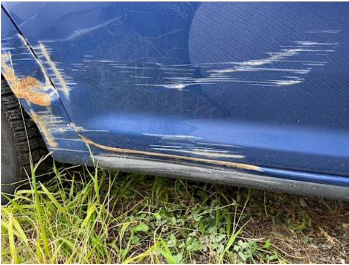
Schweller rechts (Lackschaden, Verformung)
