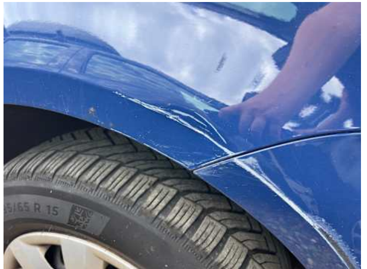
Kotflügel vorne rechts (Kratzer, Lackschaden, Verformung)
