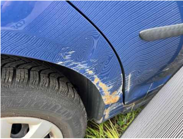
Seitenteil hinten rechts (Kratzer, Lackschaden, Rost, Verformung)
