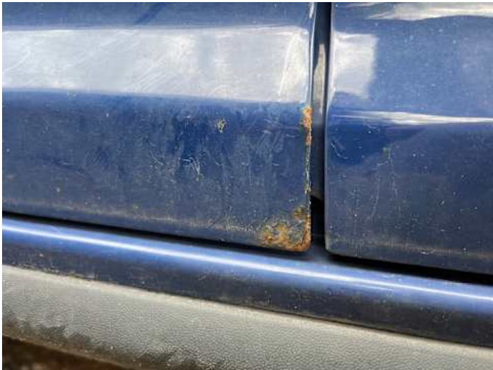
Fahrertür (Lackschaden, Rost)
