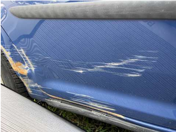
Türe hinten rechts (Kratzer, Lackschaden, Verformung)
