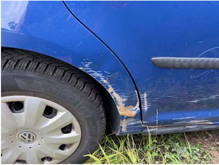
Seitenteil hinten rechts (Kratzer, Lackschaden, Rost, Verformung)
