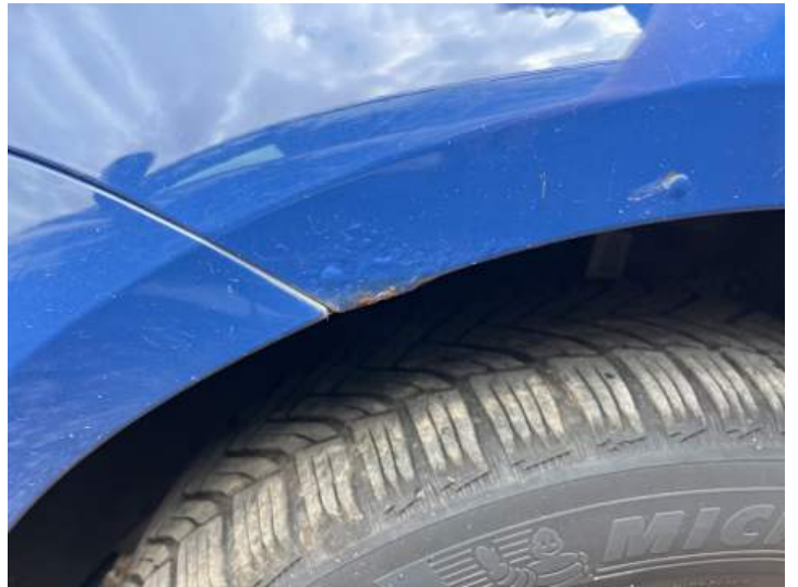
Kotflügel vorne links (Rost, Lackschaden)
