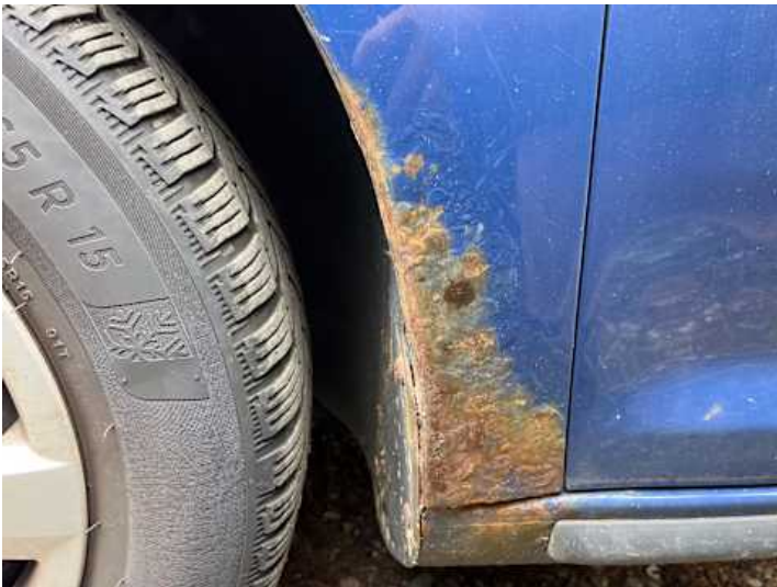
Kotflügel vorne links (Rost, Lackschaden)
