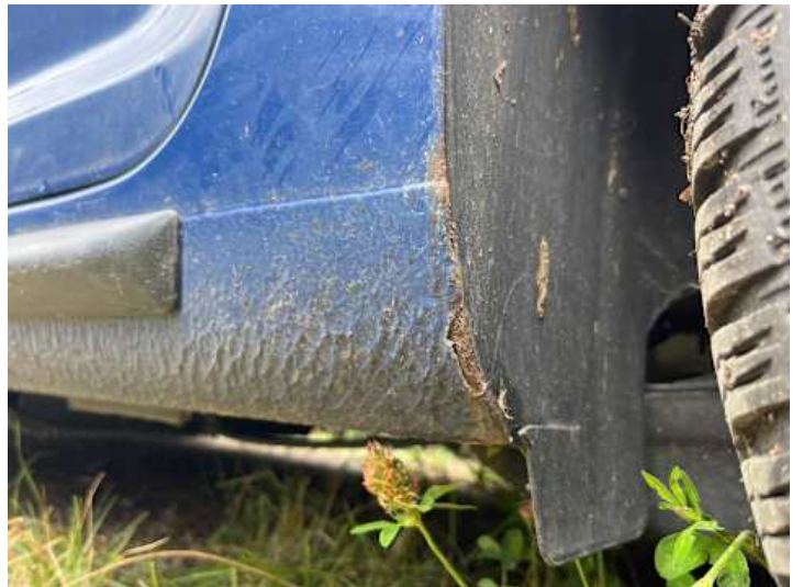
Schweller links (Rost, Lackschaden)
