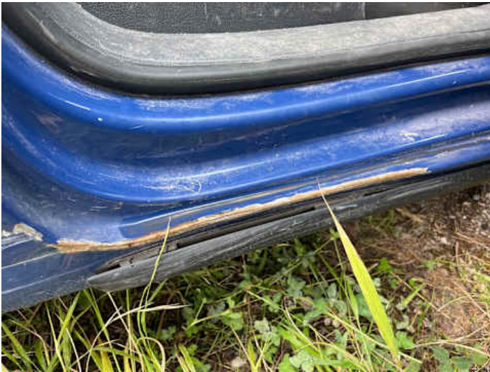
Schweller rechts (Lackschaden, Verformung)
