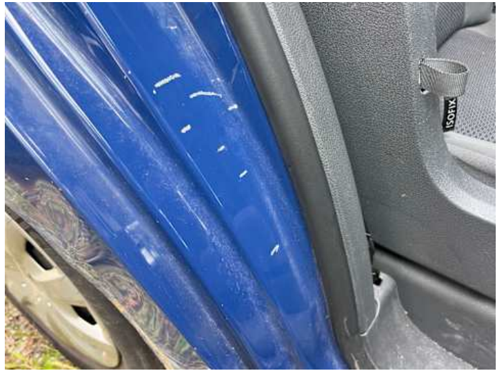
Schweller rechts (Lackschaden, Verformung)
