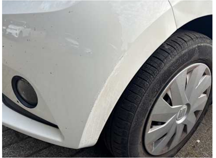
Stoßstange vorne (Kratzer, Lackschaden)
