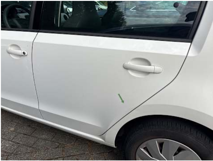
Türe hinten links (Delle)
