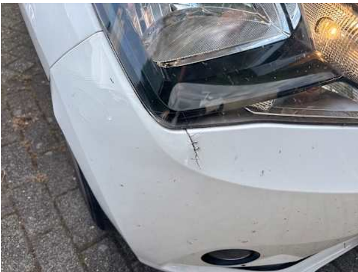
Stoßstange vorne (Kratzer, Lackschaden, Riss/Bruch, Spaltmaße ungenau)
