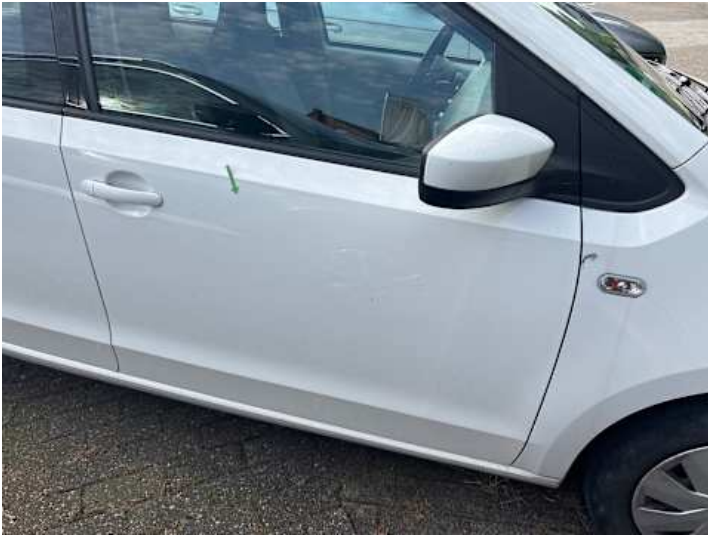
Beifahrtür (Delle, Lackschaden, Kratzer)
