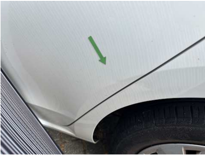
Türe hinten links (Delle)
