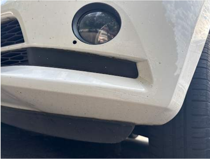
Stoßstange vorne (Kratzer, Lackschaden)
