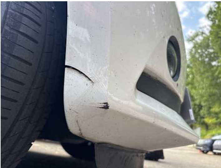
Stoßstange vorne (Kratzer, Lackschaden, Riss/Bruch, Spaltmaße ungenau)
