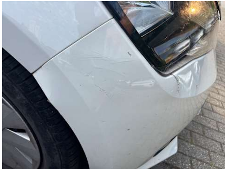
Stoßstange vorne (Kratzer, Lackschaden, Riss/Bruch, Spaltmaße ungenau)
