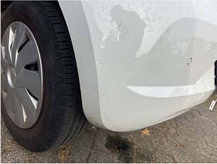
Stoßstange hinten (Kratzer, Lackschaden)
