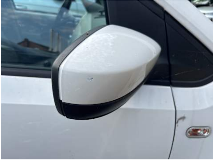
Beifahrtür (Kratzer, Lackschaden)
