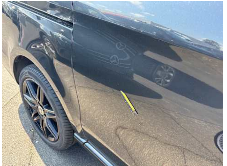
Türe hinten rechts (Delle, Kratzer)
