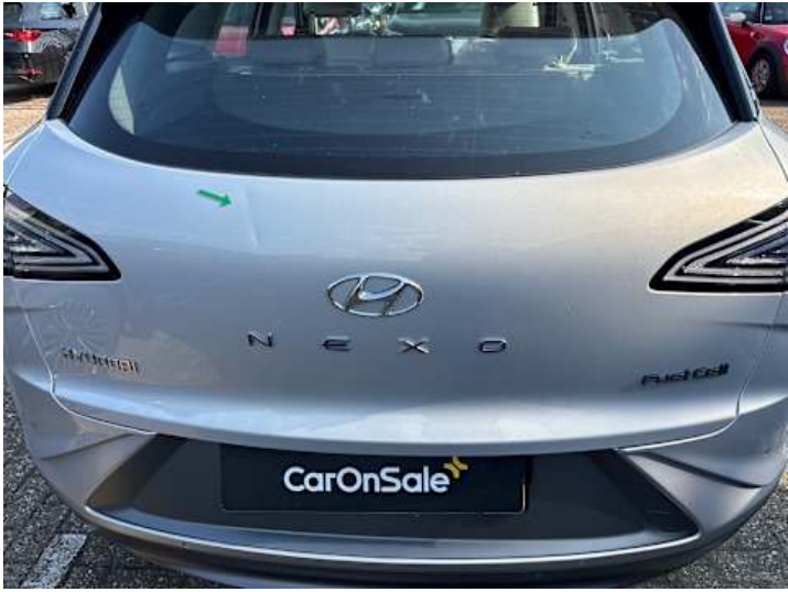
Heckklappe (Verformung, Kratzer)
