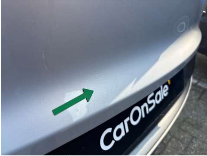
Heckklappe (Verformung, Kratzer)
