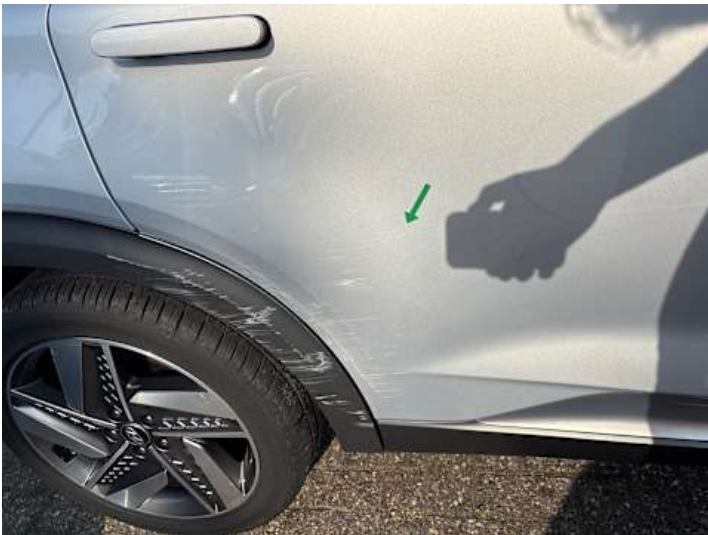
Türe hinten rechts (Kratzer, Verformung)
