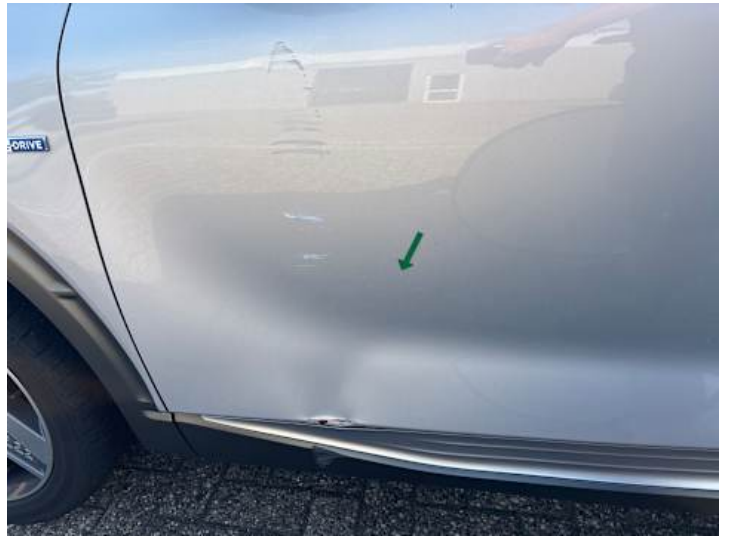
Fahrer­tür (Verformung, Rost)
