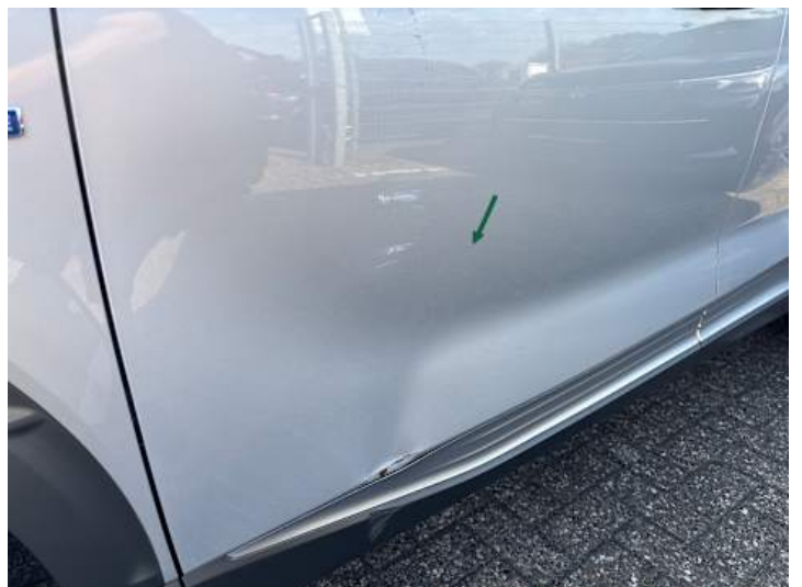
Fahrtür (Verformung, Rost)
