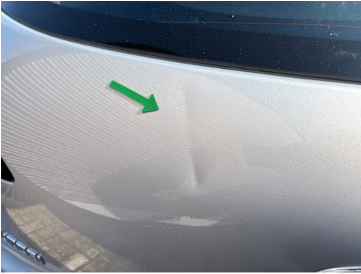
Heckklappe (Verformung, Kratzer)
