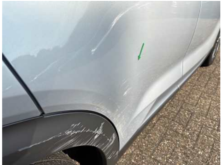
Türe hinten rechts (Kratzer, Verformung)
