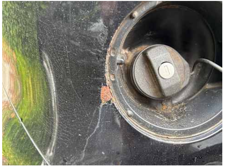
Seitenteil hinten rechts (Lackschaden, Rost)
