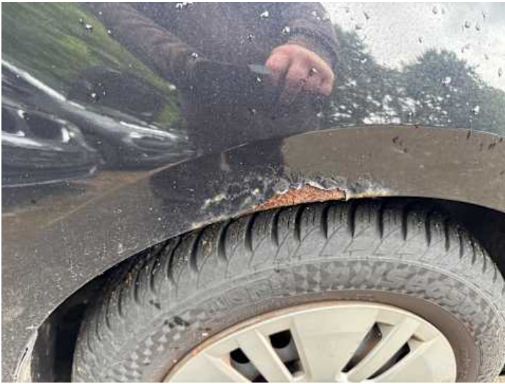
Kotflügel vorne rechts (Rost, Lackschaden)
