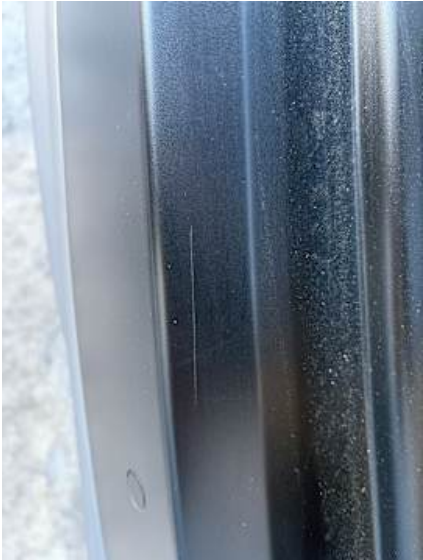
Stoßstange hinten (Kratzer, Verformung)
