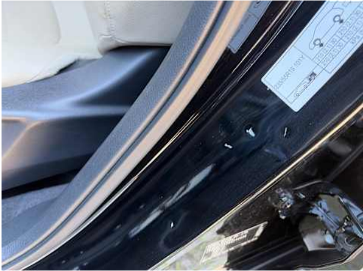
Schweller links (Kratzer, Lackschaden, Delle)
