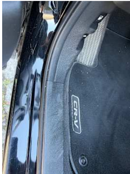
Schweller links (Kratzer, Lackschaden, Delle)
