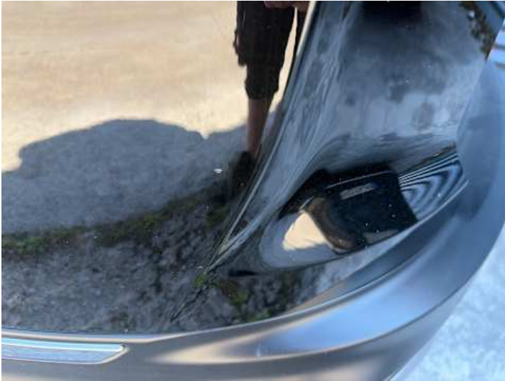
Stoßstange hinten (Kratzer, Lackschaden)
