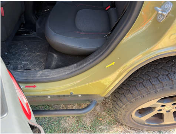
Türe hinten links (Kratzer, Delle)
