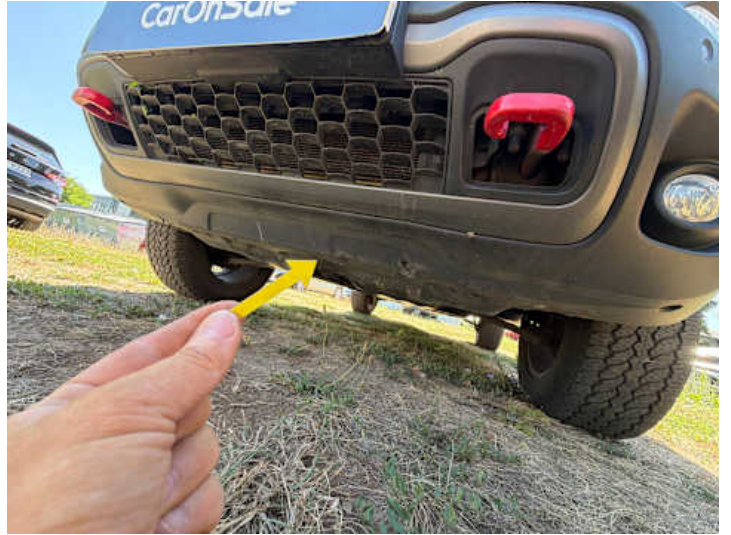
Stoßstange vorne (Riss/Bruch, Kratzer)
