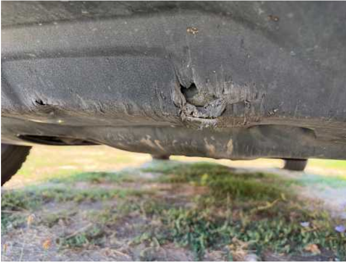
Stoßstange vorne (Riss/Bruch, Kratzer)
