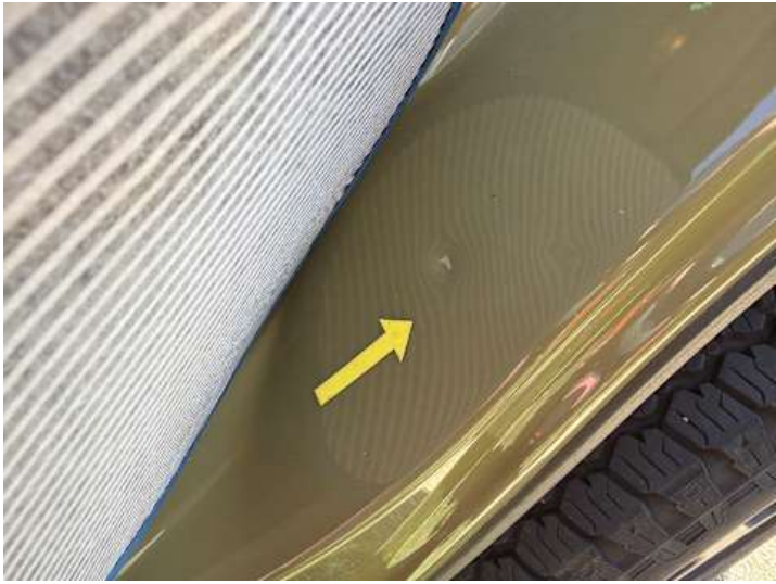
Türe hinten links (Kratzer, Delle)
