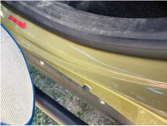
Türe hinten links (Kratzer, Delle)
