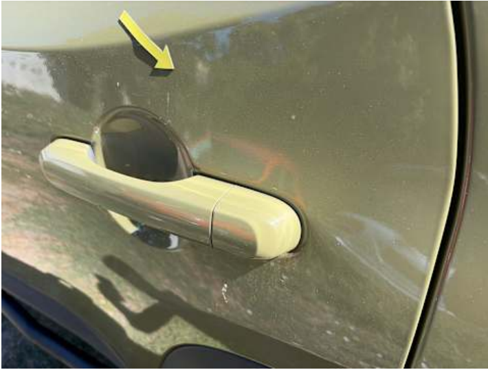
Türe hinten links (Kratzer, Delle)
