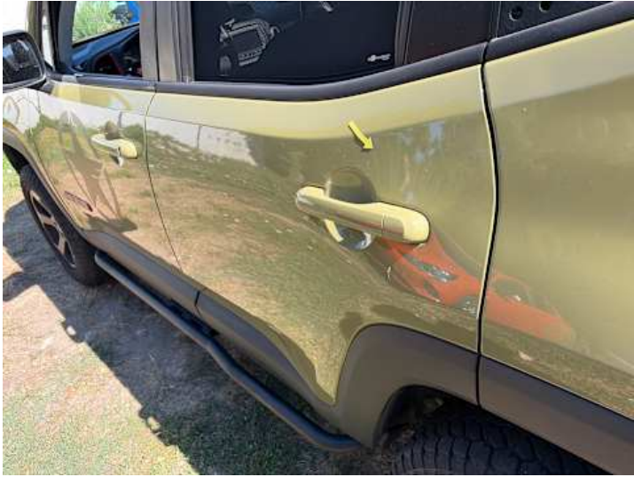
Türe hinten links (Kratzer, Delle)
