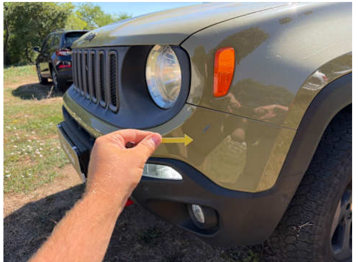
Stoßstange vorne (Lackschaden, Kratzer)
