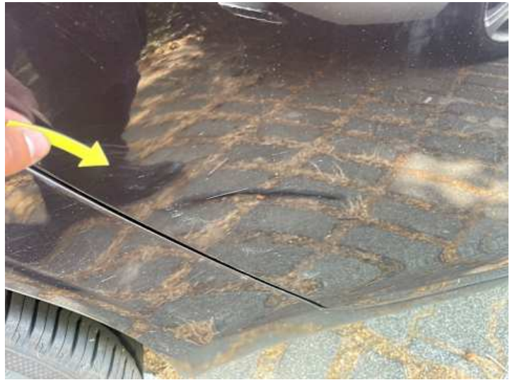
Türe hinten rechts (Kratzer)
