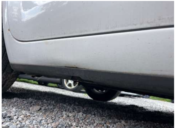
Schweller rechts (Verformung)
