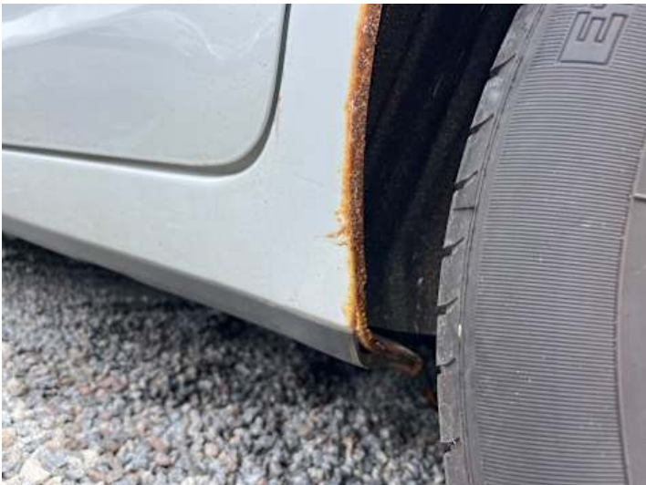
Schweller links (Rost)
