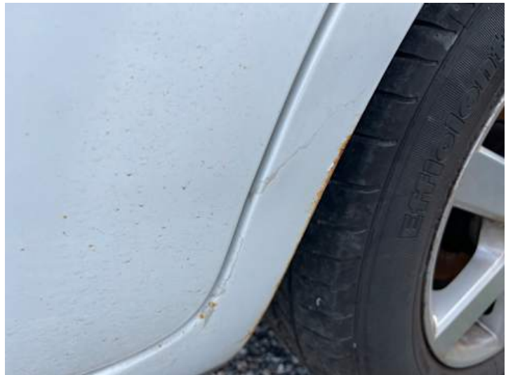
Seitenteil hinten links (Lackschaden)
