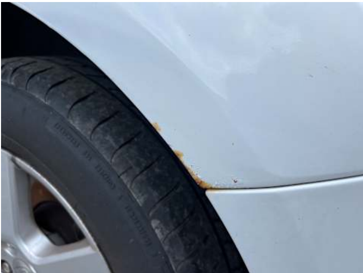
Seitenteil hinten links (Rost)
