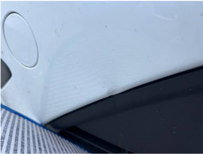
Stoßstange vorne (Verformung)
