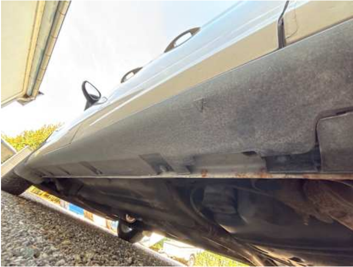
Schweller links (Rost)
