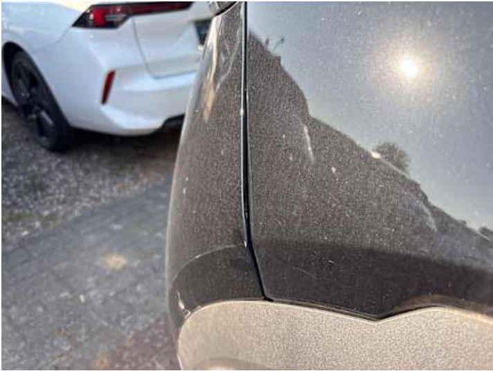
Stoßstange hinten (Spaltmaße ungenau)
