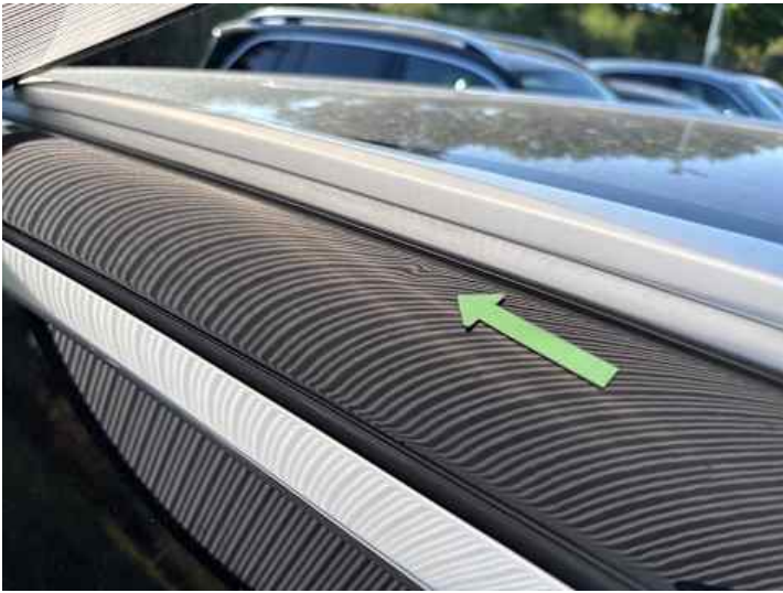
Seitenteil hinten rechts (Delle)
