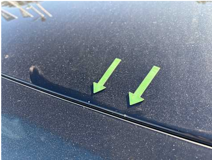
Dach (Steinschlag, Lackschaden)
