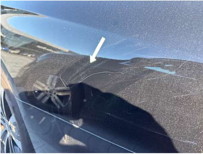
Seitenteil hinten links (Kratzer)
