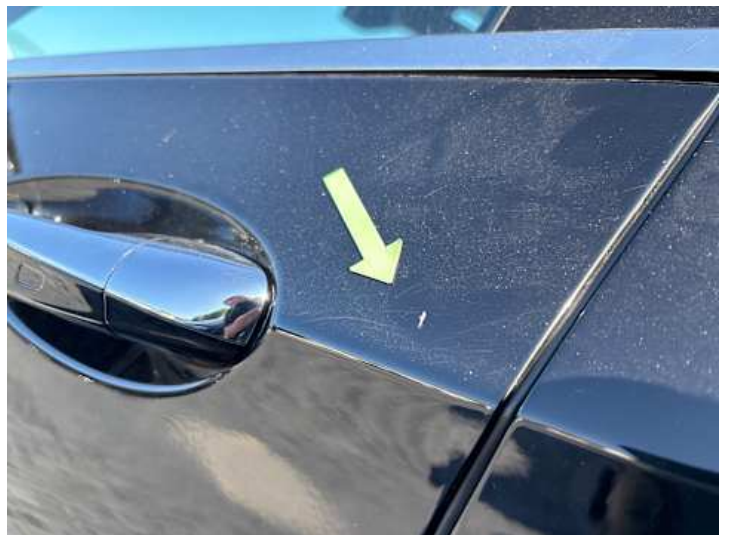
Fahrtür (Kratzer, Lackschaden)
