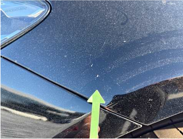
Kotflügel vorne links (Steinschlag, Spaltmaße ungenau)
