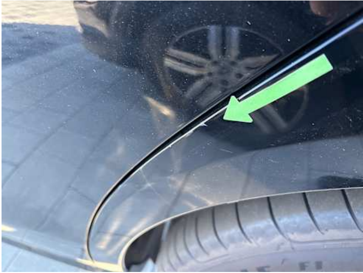
Seitenteil hinten links (Lackschaden)
