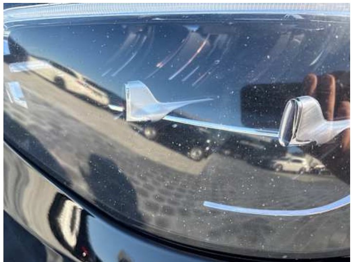
Scheinwerfer (links) (Kratzer, Steinschlag)
