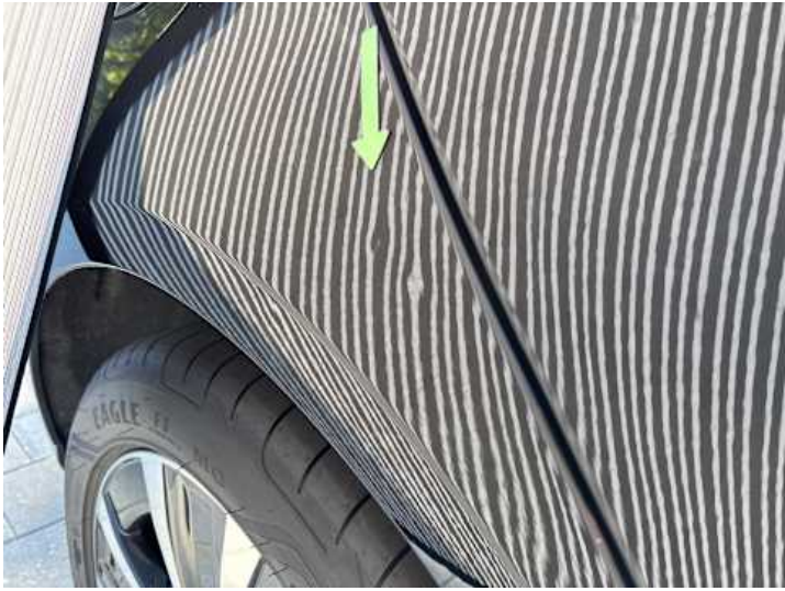
Seitenteil hinten rechts (Delle)
