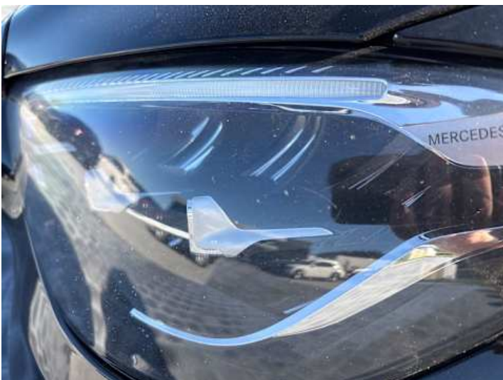
Scheinwerfer (links) (Kratzer, Steinschlag)
