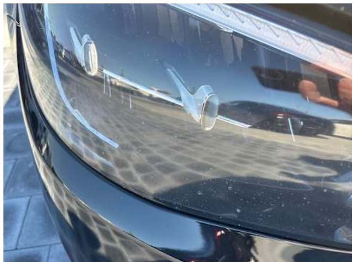
Scheinwerfer (rechts) (Steinschlag)
