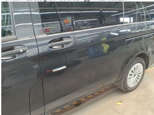
Beschädigung #6: Schiebetür links: Schiebetür mit Glasscheibe - Delle(n) - instandsetzen und lackieren
