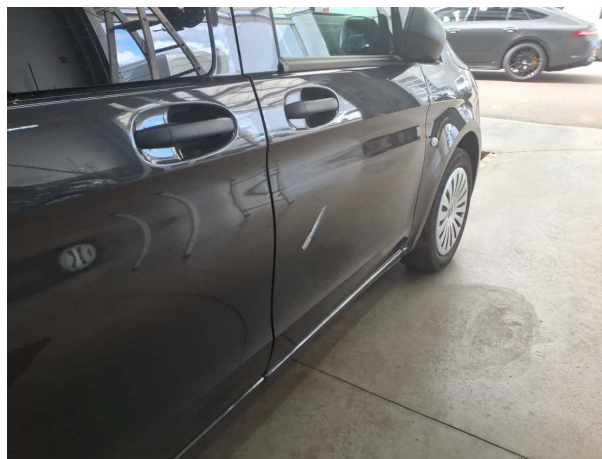
Beschädigung #2: Tür vorn rechts: Tür - Delle(n) - Smart Repair
