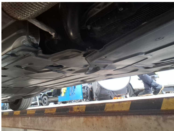
Beschädigung #1: Motor: Motorverkleidung unten - lose - de-/montieren
