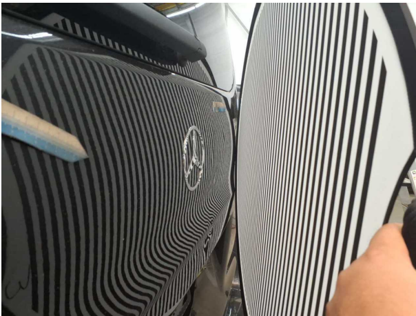
Beschädigung #10: Heckklappe/-tür: Heckklappe verglast - Delle(n) - instandsetzen/lackieren (S1)
