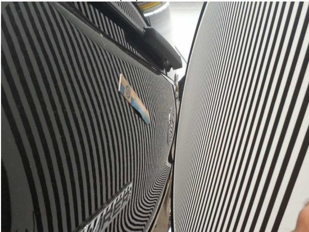
Beschädigung #10: Heckklappe/-tür: Heckklappe verglast - Delle(n) - instandsetzen/lackieren (S1)
