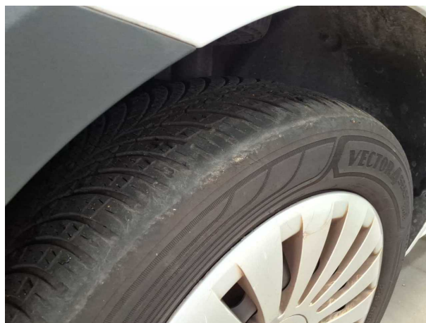
Beschädigung #11: Rad/Reifen: Reifen vorn links - verschlissen - erneuern
