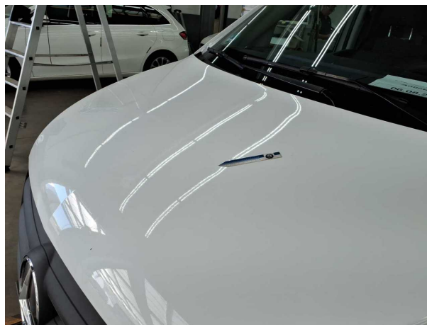
Beschädigung #3: Motorhaube: Motorhaube - Delle(n) - Smart Repair
