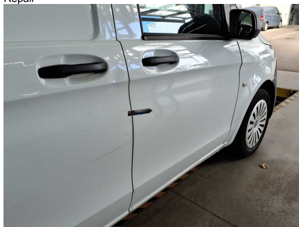
Beschädigung #7: Tür vorn rechts: Tür - Delle(n) - Smart Repair
