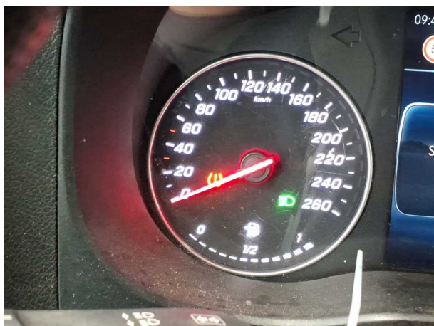
Beschädigung #10: Instrumententafel: Kontrollleuchte (Mehrkosten möglich) - leuchtet - Diagnose durchführen
