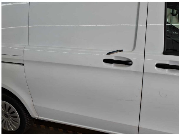
Beschädigung #14: Schiebetür rechts: Schiebetür - Delle(n) - Smart Repair
