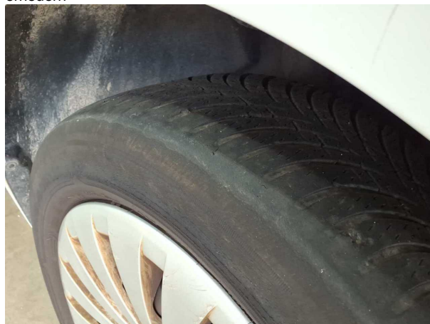
Beschädigung #12: Rad/Reifen: Reifen vorn rechts - verschlisse... erneuern
