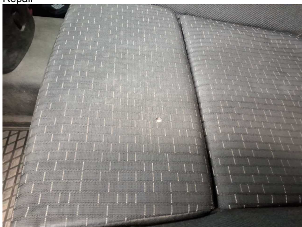
Beschädigung #15: Sitz vorn: Sitzbezug links - Brandloch - erneuern
