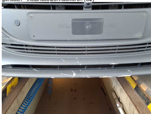
Beschädigung #19: Stossfänger vorn: Stossfänger mit Parktronic (Verschmutz und) - verformt - erneuern
