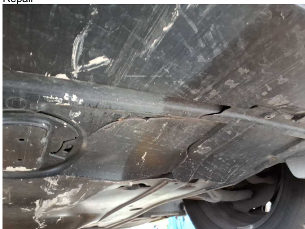
Beschädigung #9: Motor: Motorverkleidung unten - gebrochen / gerissen - erneuern
