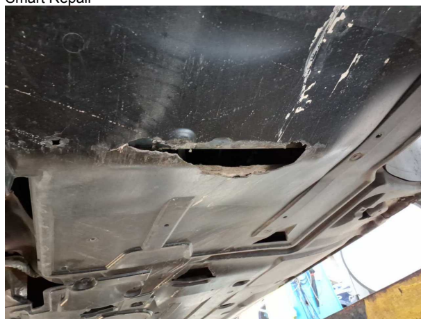
Beschädigung #9: Motor: Motorverkleidung unten - gebrochen / gerissen - erneuern
