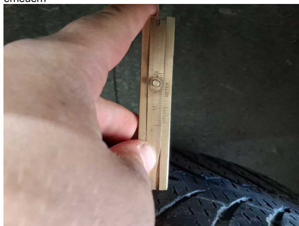
Beschädigung #13: Rad/Reifen: Reifen hinten rechts - verschlissen - erneuern
