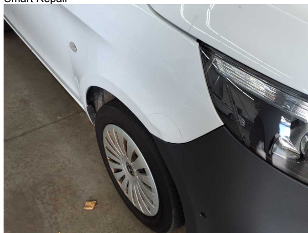
Beschädigung #16: Kotflügel rechts: Kotflügel rechts - verformt - erneuern
