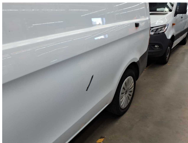
Beschädigung #6: Seitenwand links: Seitenwand - Delle(n) - Smart Repair
