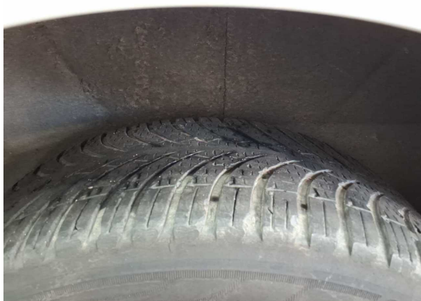
Beschädigung #13: Rad/Reifen: Reifen hinten rechts - verschlissen - erneuern
