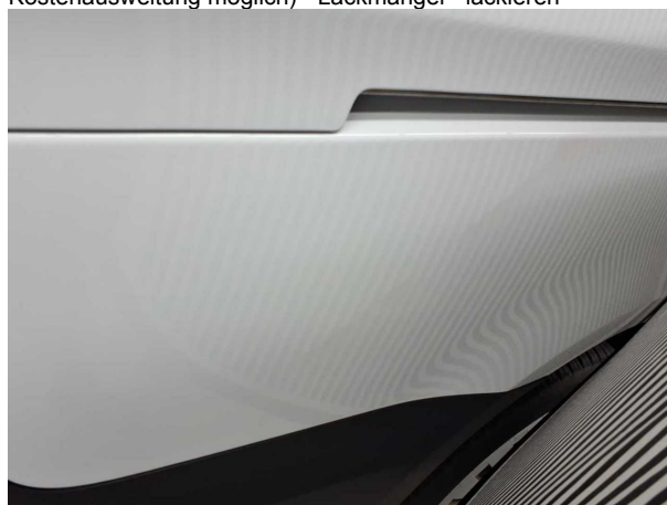
Beschädigung #4: Seitenwand rechts: Seitenwand (Farbnebel; Kostenausweitung möglich) - Lackmangel - lackieren
