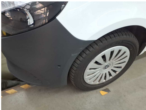
Beschädigung #3: Stossfänger vorn: Stossfänger mit Parktronic - verkratzt / verschürft - erneuern
