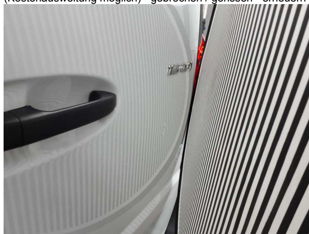
Beschädigung #2: Heckklappe/-tür: Hecktür links (und rechts) - Delle(n) - Smart Repair
