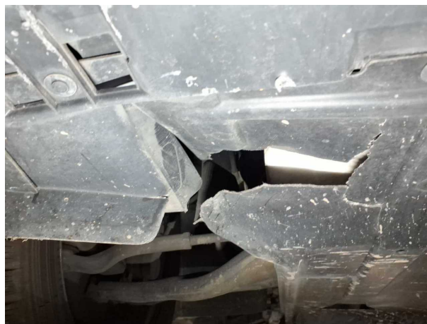
Beschädigung #1: Motor: Motorverkleidung unten (Kostenausweitung möglich) - gebrochen / gerissen - erneuern
