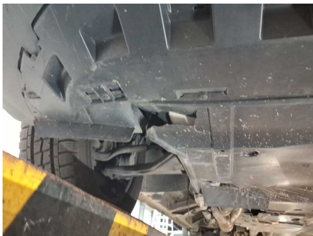
Beschädigung #1: Motor: Motorverkleidung unten (Kostenausweitung möglich) - gebrochen / gerissen - erneuern
