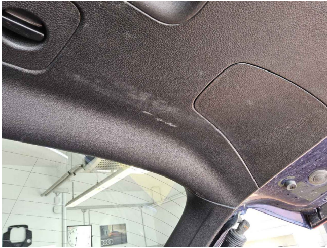
Heckklappenverkleidung Kratzer (DEKRA)
