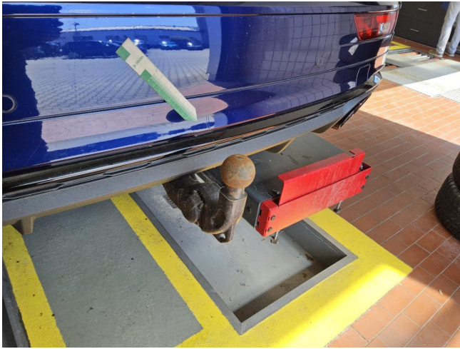
Stoßfängerverkleidung hinten, Unterteil, verschrammt (DEKRA)
