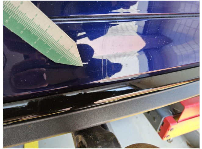
Stoßfängerverkleidung hinten, Unterteil, verschrammt (DEKRA)
