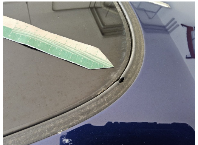
Dichtung außen für Glasschiebedach eingerissen (DEKRA)
