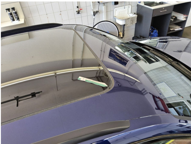
Dichtung außen für Glasschiebedach eingerissen (DEKRA)
