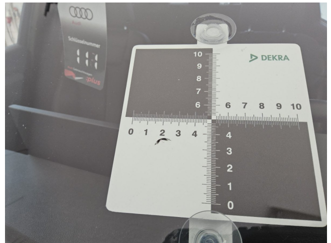
Frontscheibe 2x Steinschläge mit Rissbildung, einer im Sichtfeldbereich Fahrerseite (DEKRA)
