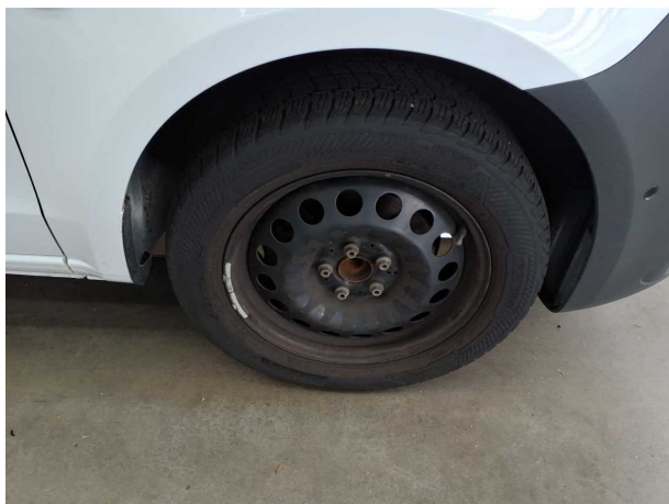
Beschädigung #1: Rad/Reifen: Radblende vorn rechts - fehlt - erneuern
