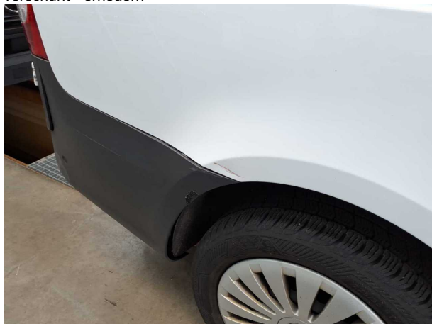
Beschädigung #7: Seitenwand rechts: Seitenwand (Unterhalb) - Dell... Lackschaden - instandsetzen und lackieren
