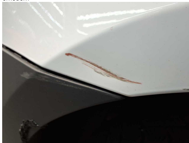
Beschädigung #7: Seitenwand rechts: Seitenwand (Unterhalb) - Delle / Lackschaden - instandsetzen und lackieren
