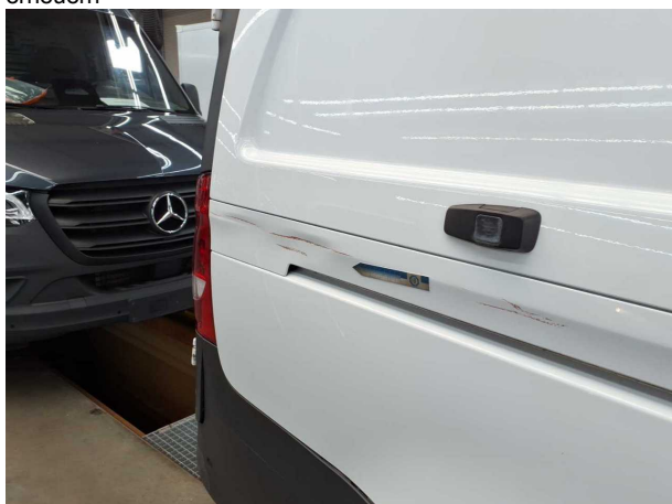
Beschädigung #3: Seitenwand rechts: Schutzleiste - verformt - erneuern
