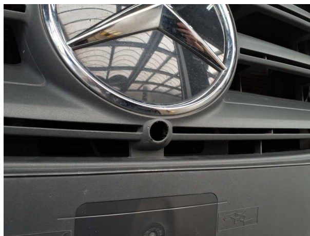
Beschädigung #6: Stossfänger vorn: Parksensoren Mitte - fehlt - erneuern
