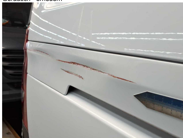
Beschädigung #3: Seitenwand rechts: Schutzleiste - verformt - erneuern
