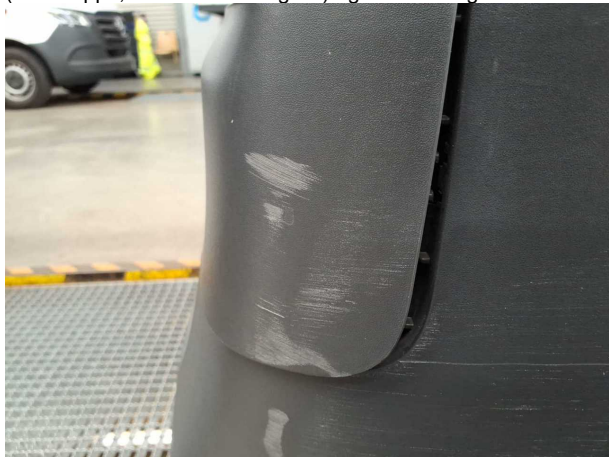
Beschädigung #9: Stossfänger hinten: Stossfänger mit Parktronic (Inkl. Kappe, Mehrkosten möglich) - gebrochen / gerissen - erneuern
