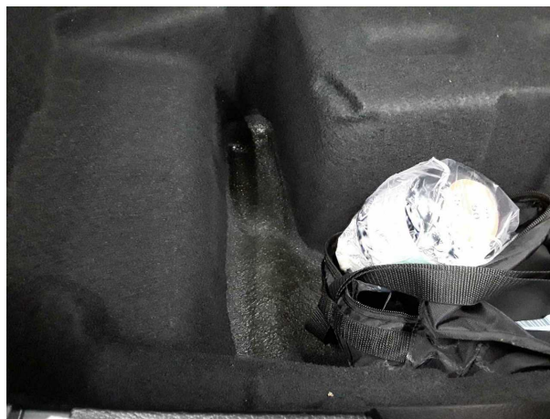
Beschädigung #2: Interieur: Laderaumboden (Mehrkosten können entstehen) - verschmutzt - erneuern
