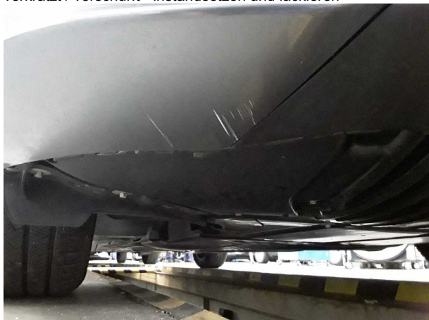
Beschädigung #3: Stossfänger vorn: Stossfänger mit Parktronic - verkratzt / verschürft - instandsetzen und lackieren
