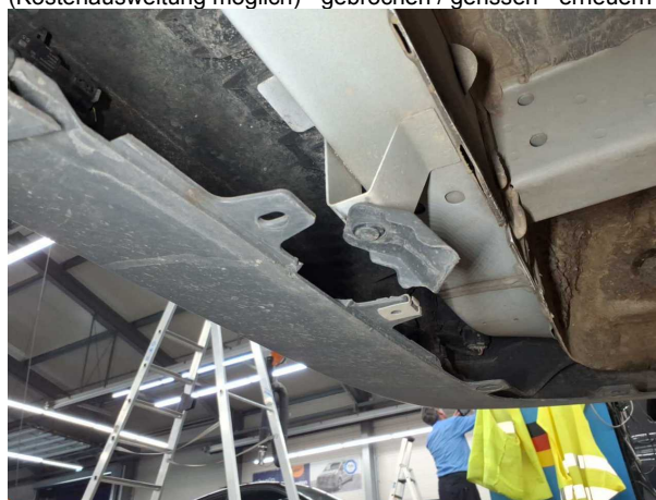
Beschädigung #11: Stossfänger hinten: Stossfänger mit Parktro... (Kostenausweitung möglich) - gebrochen / gerissen - erneuern
