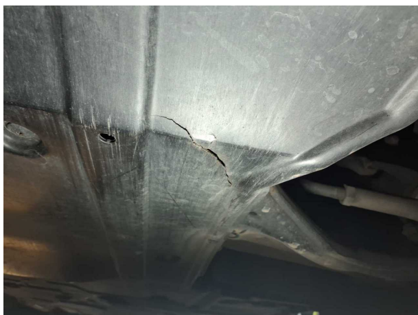
Beschädigung #7: Motor: Motorverkleidung unten (Kostenausweitung möglich) - gebrochen / gerissen - erneuern
