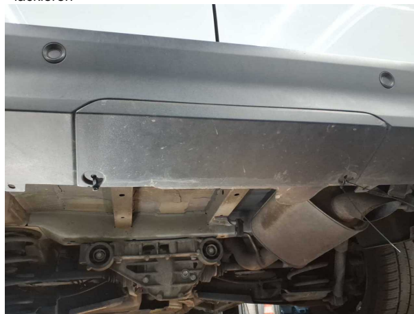
Beschädigung #11: Stossfänger hinten: Stossfänger mit Parktro... (Kostenausweitung möglich) - gebrochen / gerissen - erneuern
