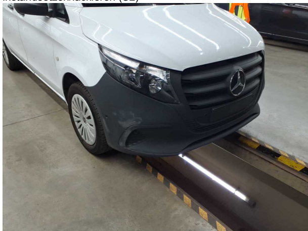
Beschädigung #13: Stossfänger vorn: Stossfänger mit Parktronic (Kostenausweitung möglich) - verkratzt / verschürft - erneuern
