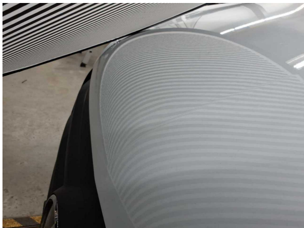
Beschädigung #5: Motorhaube: Motorhaube - Delle(n) - Smart Repair
