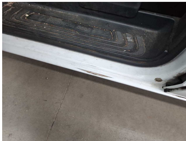
Beschädigung #9: Schweller links: Einstieg - verkratzt / verschürft - lackieren
