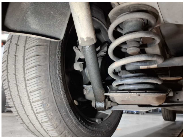
Beschädigung #8: Hinterachse: Stoßdämpfer links (Kostenausweitung möglich) - undicht - befunden ggf. instandsetzen
