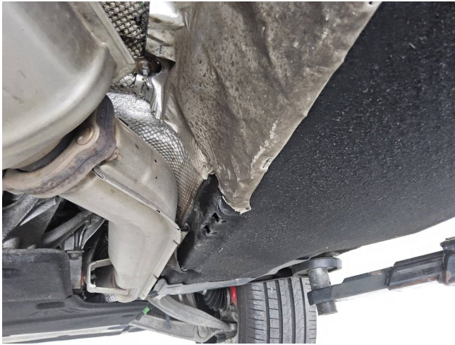
Hitzeschutzblech rechts gebrochen (DEKRA)
