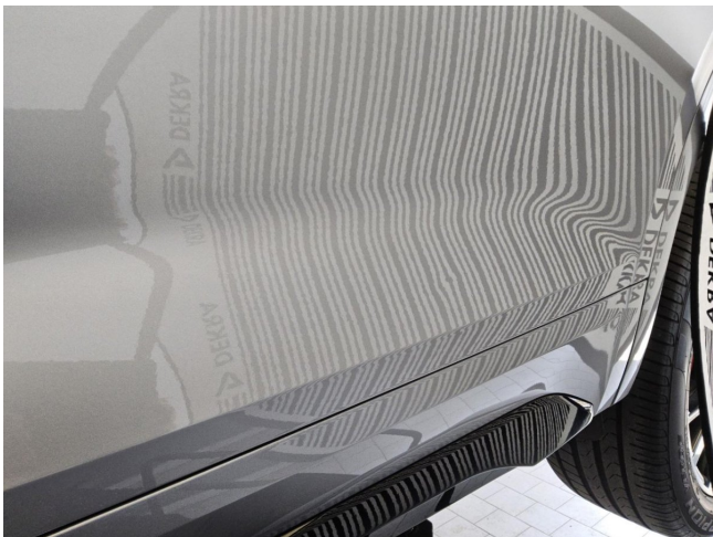
Tür hinten links, eingedellt, drücken (DEKRA)
