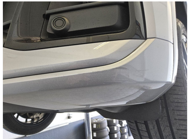
Spoiler vorne links zerkratzt (DEKRA)
