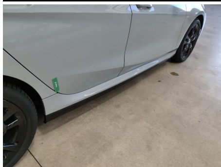
Schwellerabdeckung / Rechts / Kratzer
