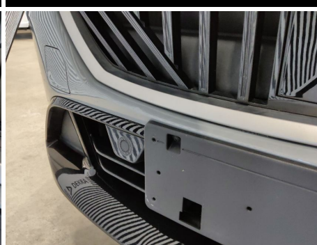
Stoßfänger / Vorne / Delle
