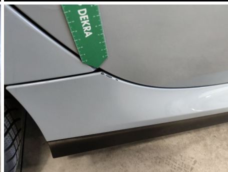
Schwellerabdeckung / Rechts / Kratzer
