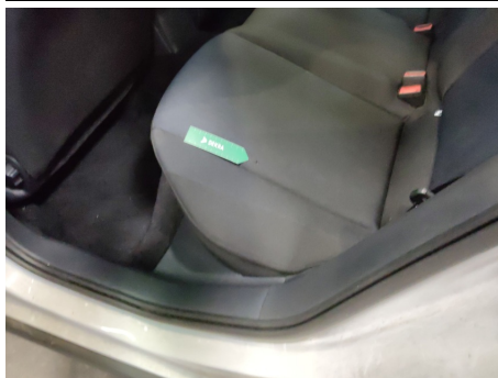
Sitzbezug / Hinten Links / Brandstelle
