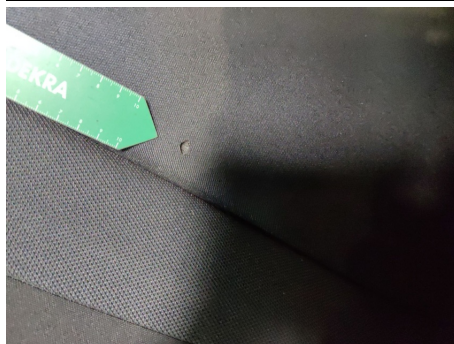
Sitzbezug / Hinten Links / Brandstelle
