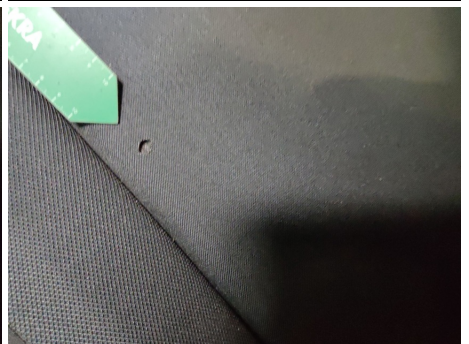
Sitzbezug / Hinten Links / Brandstelle
