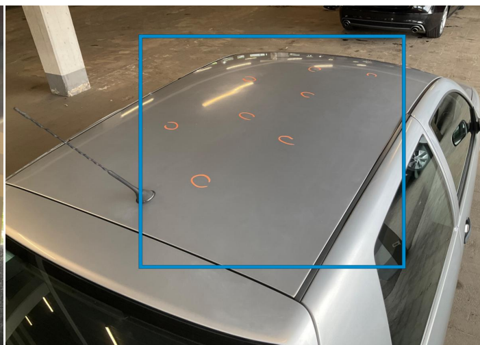
12. Dach Karosserie / Delle / Hagelschaden -
