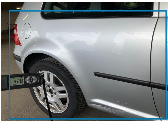
1. Kotflügel / Hinten Rechts Lack / schlechte Verarbeitung -
