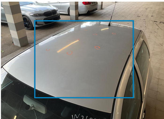
9. Dach Karosserie / Delle / Hagelschaden -
