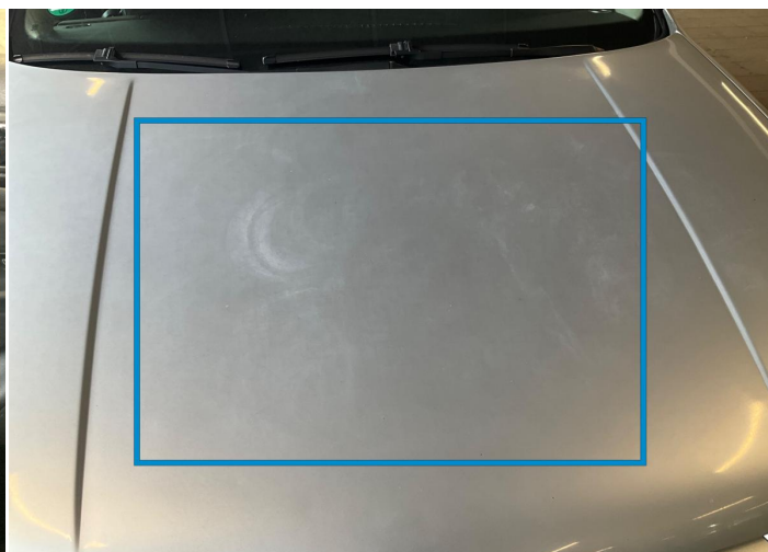
8. Haube / Vorn Lack / schlechte Verarbeitung -
