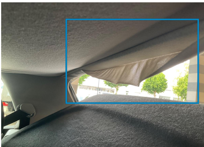
11. Dach - Polsterung Innenraum / Nichtkonform -
