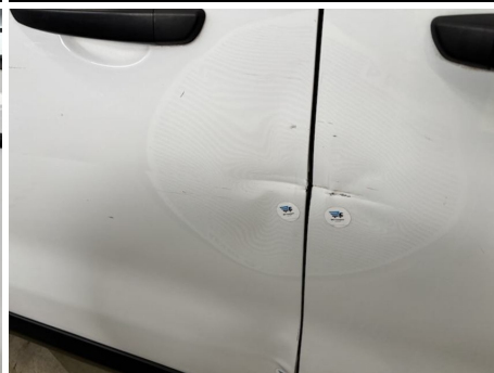
Tür / Rechts / Delle
