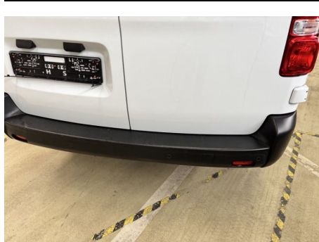
Stoßfänger / Hinten / Gebrochen
