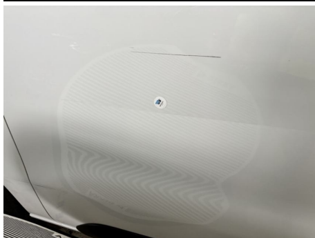
Tür / Rechts / Delle
