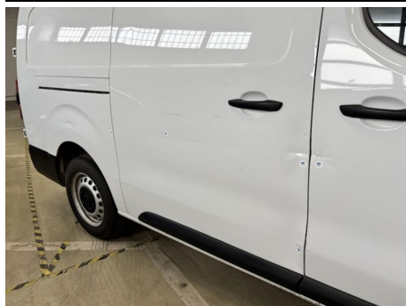
Tür / Rechts / Delle
