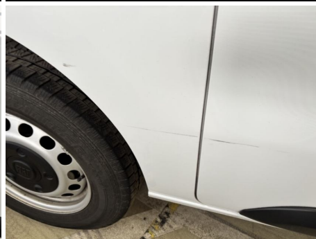
Seitenwand / Hinten Rechts / Delle
