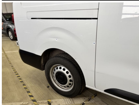
Seitenwand / Hinten Rechts / Delle
