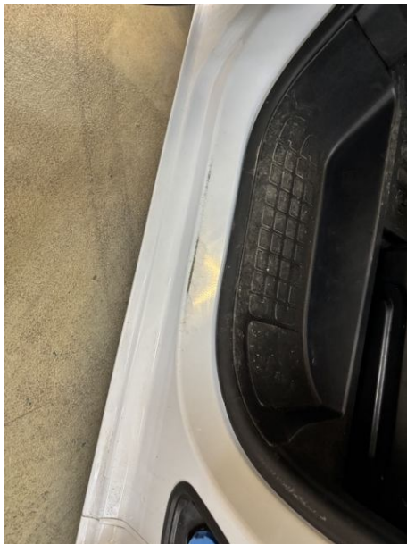
Türeinstieg / Vorne Links / Kratzer
