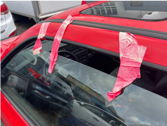
Fahrertür (Unsachgemäß instand gesetzt)
