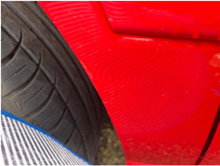
Kotflügel vorne links (Lackschaden, Kratzer, Delle)
