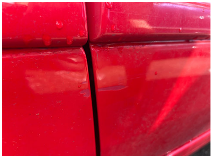
Fahrtür (Lackschaden, Kratzer)
