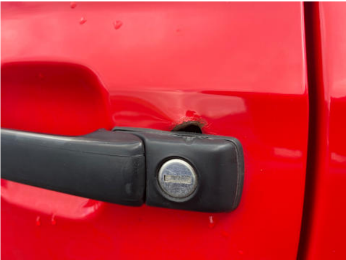
Fahrertür (Rost, Verformung)
