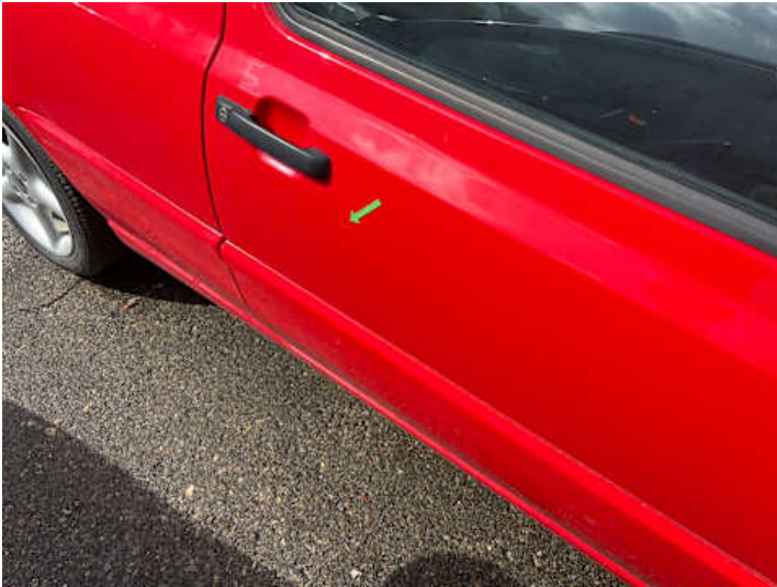
Beifahrertür (Lackschaden, Kratzer)
