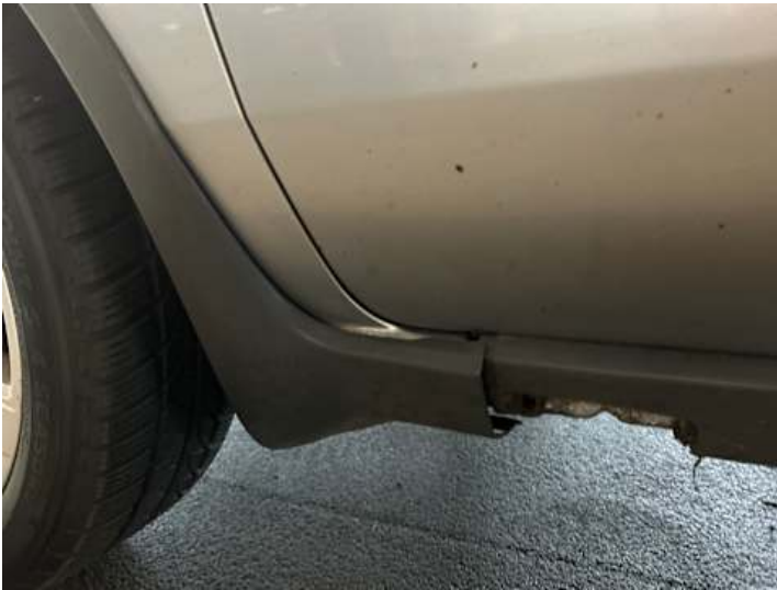
Kotflügel vorne links (Riss/Bruch)
