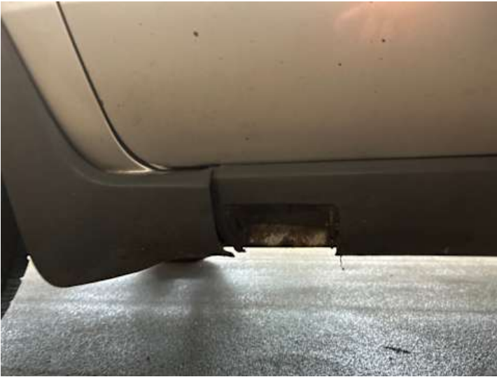
Schweller links (Lackschaden, Riss/Bruch)
