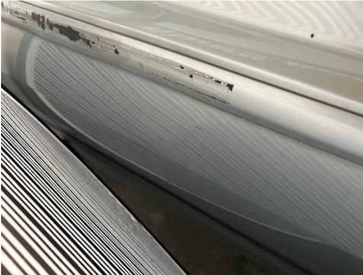
Beifahrertür (Delle, Riss/Bruch, Lackschaden, Verformung)
