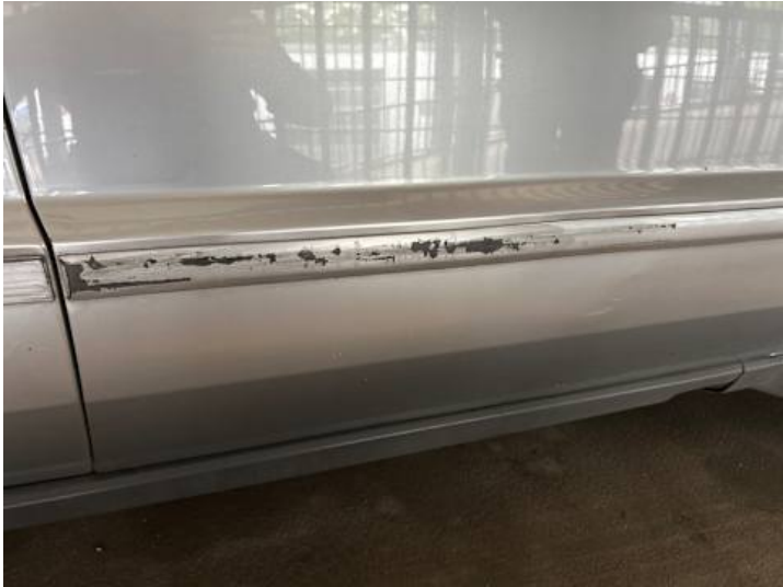
Beifahrertür (Delle, Riss/Bruch, Lackschaden, Verformung)
