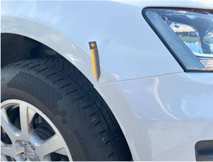
Kotflügel vorne rechts (Lackschaden)
