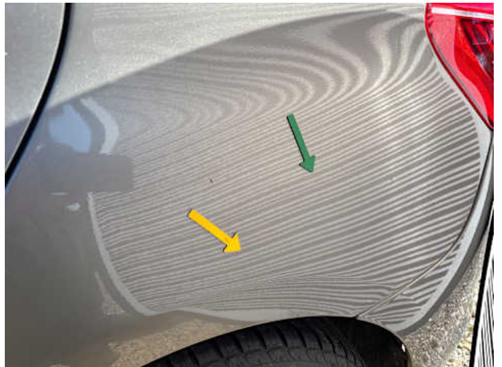
Seitenteil hinten links (Lackschaden, Unsachgemäß instand gesetzt)
