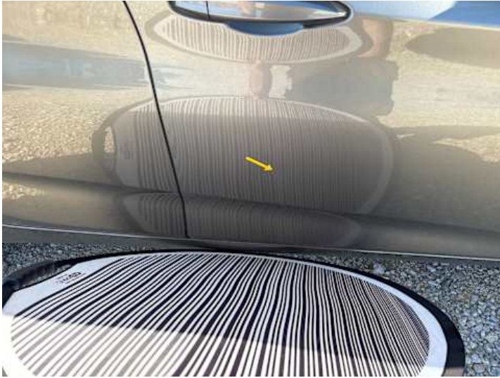
Beifahrertür (Kratzer, Delle)
