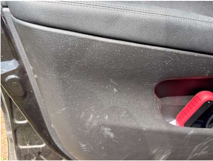
Innenraum (Kratzer, Verschleiß)
