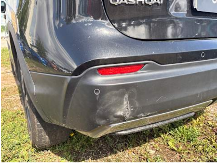
Stoßstange hinten (Kratzer, Lackschaden, Verformung, Riss/Bruch)
