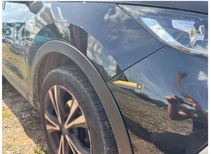
Stoßstange vorne (Kratzer, Lackschaden, Verformung)
