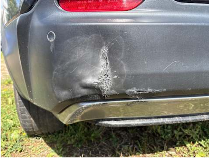
Stoßstange hinten (Kratzer, Lackschaden, Verformung, Riss/Bruch)
