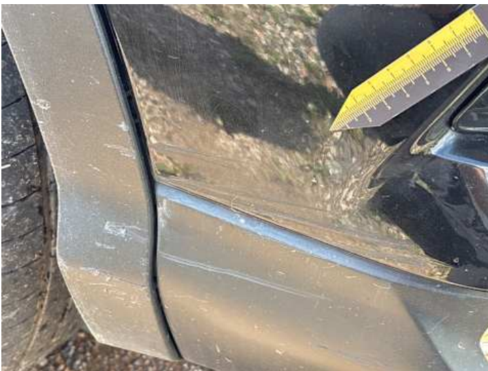
Stoßstange vorne (Kratzer, Lackschaden, Verformung)
