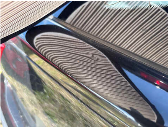
Heckklappe (Delle, Lackschaden)
