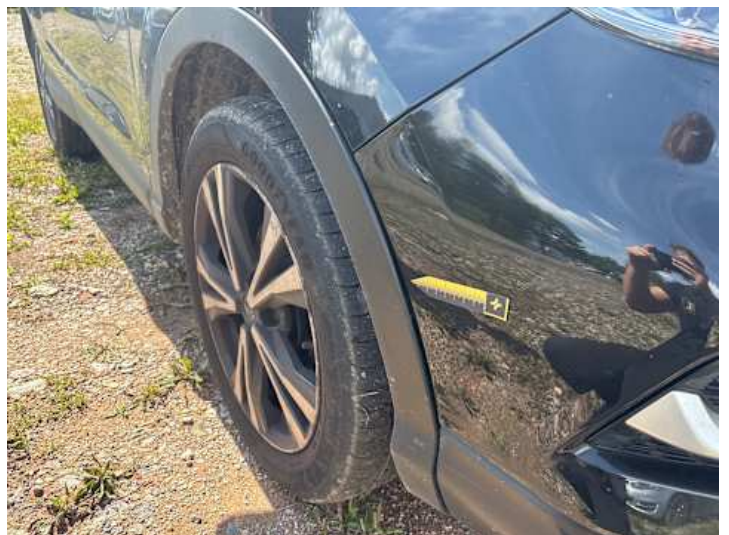
Stoßstange vorne (Spaltmaße ungenau)
