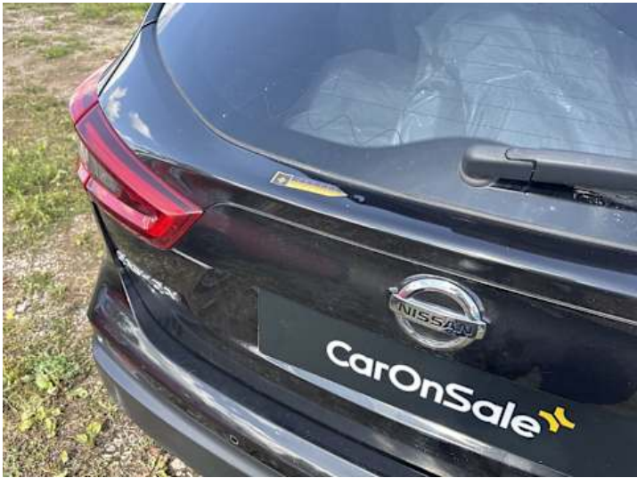
Heckklappe (Delle, Lackschaden)
