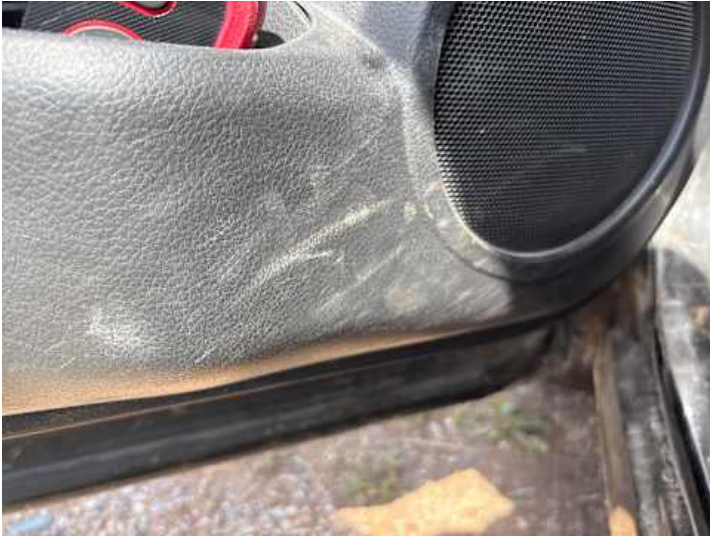
Innenraum (Kratzer, Verschleiß)
