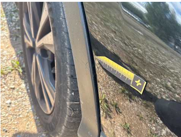
Stoßstange vorne (Spaltmaße ungenau)
