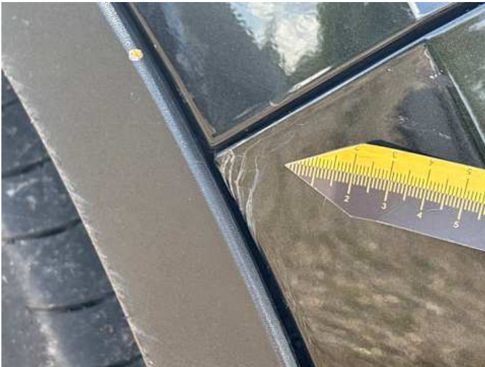
Stoßstange vorne (Kratzer, Lackschaden, Verformung)
