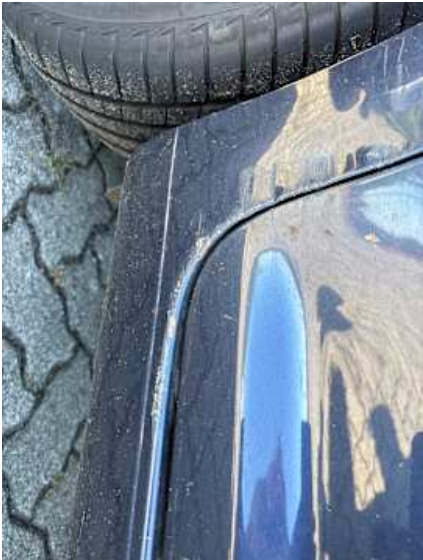
Schweller rechts (Kratzer, Verformung)
