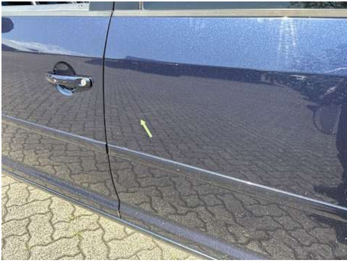
Türe hinten links (Kratzer)
