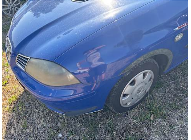
Stoßstange vorne (Spaltmaße ungenau)
