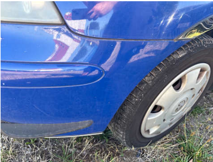
Stoßstange vorne (Spaltmaße ungenau)
