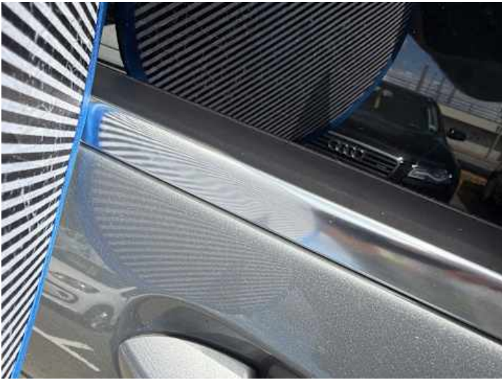
Türe hinten rechts (Delle)
