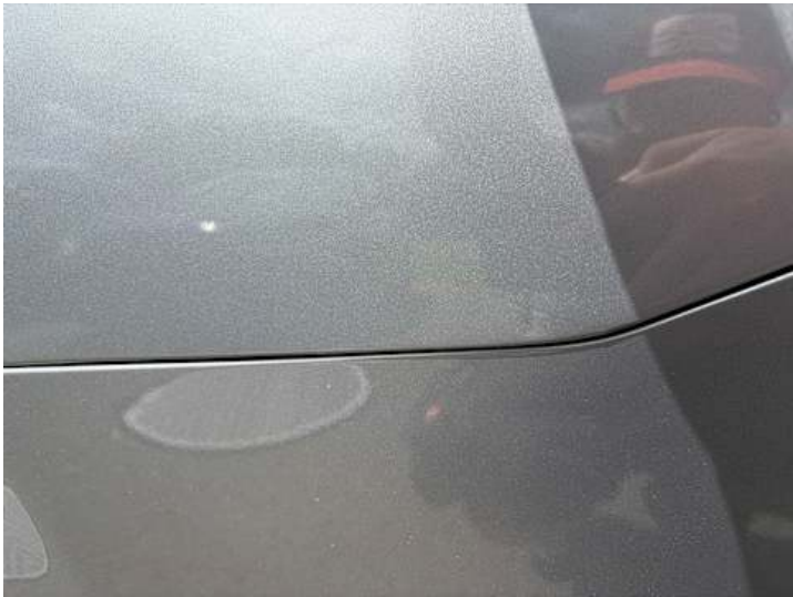
Stoßstange hinten (Spaltmaße ungenau, Riss/Bruch)
