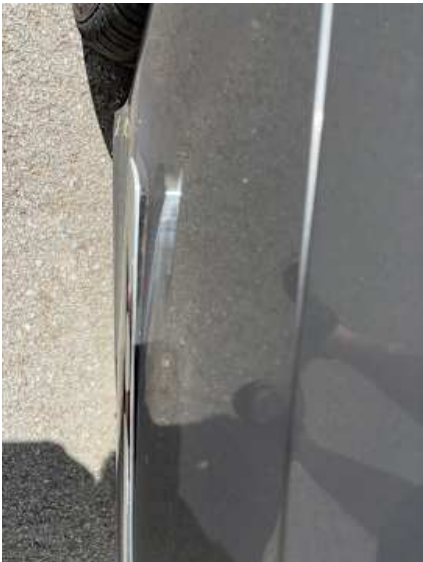
Stoßstange hinten (Spaltmaße ungenau, Riss/Bruch)
