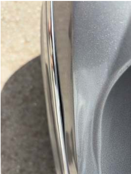
Stoßstange hinten (Spaltmaße ungenau, Riss/Bruch)
