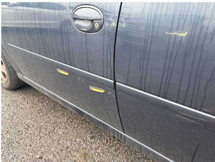
Fahrtür (Lackschaden, Kratzer)
