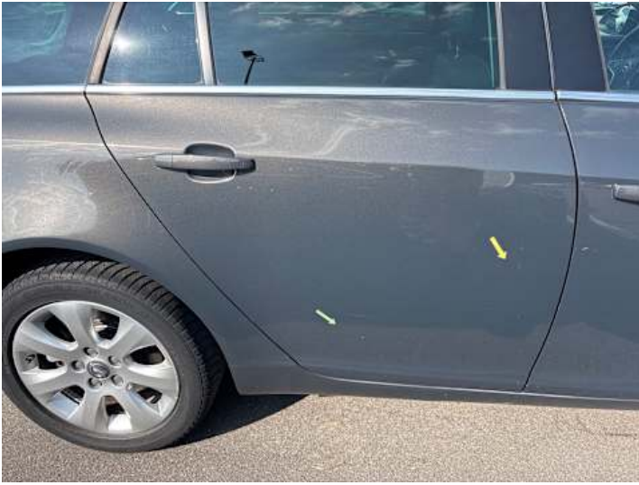
Türe hinten rechts (Kratzer)
