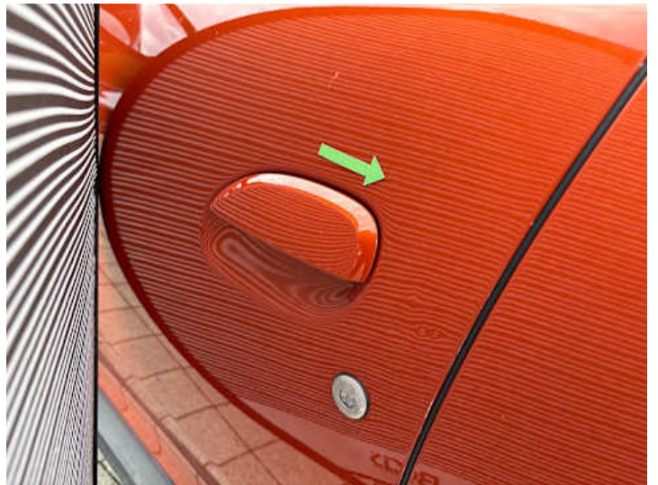
Fahrtür (Delle, Kratzer)
