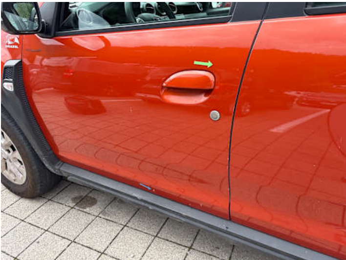
Fahrtür (Delle, Kratzer)
