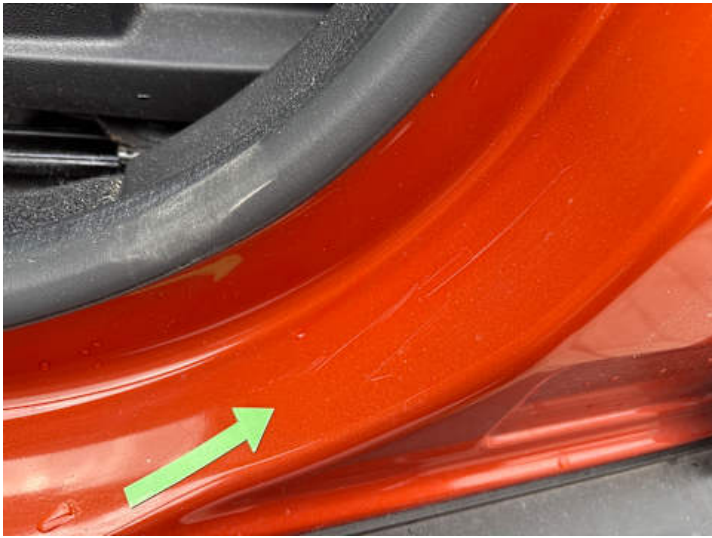
Schweller links (Kratzer)
