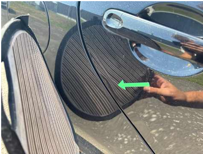
Türe hinten rechts (Verformung)
