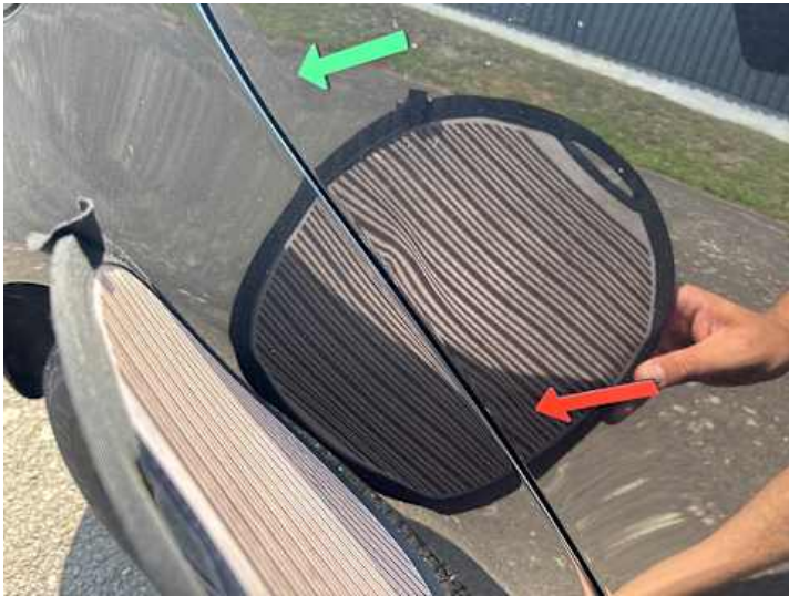
Türe hinten rechts (Verformung)
