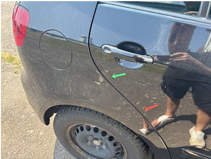
Türe hinten rechts (Verformung)
