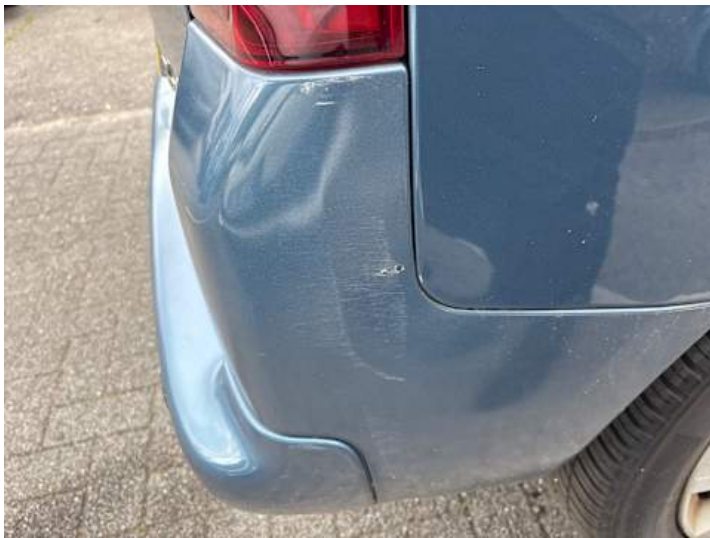
Stoßstange hinten (Kratzer, Verformung)
