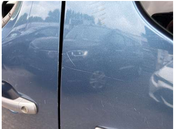
Türe hinten links (Kratzer)
