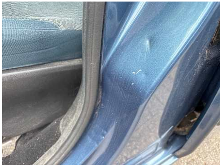
Schweller links (Kratzer, Delle)
