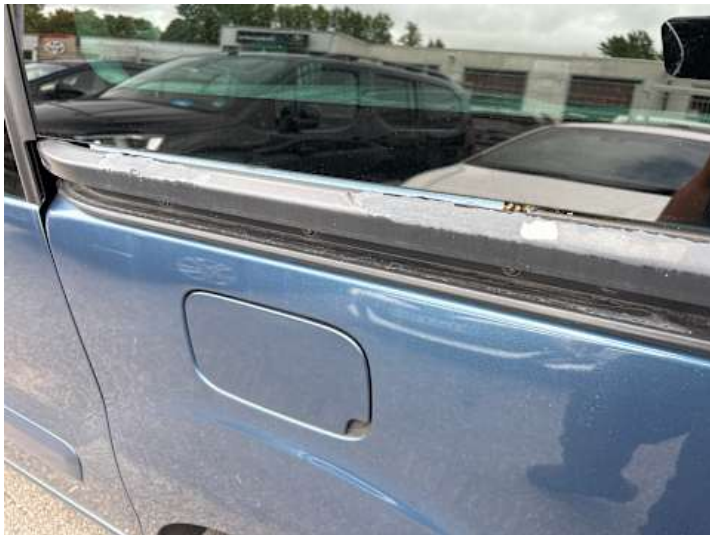
Seitenteil hinten links (Lackschaden)
