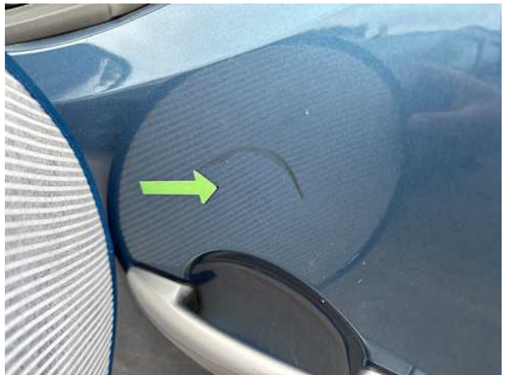
Fahrtür (Kratzer, Delle)
