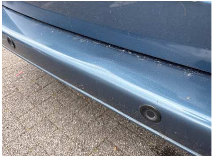
Stoßstange hinten (Kratzer, Verformung)
