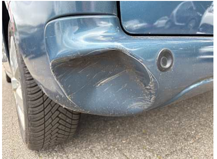
Stoßstange hinten (Kratzer, Verformung)
