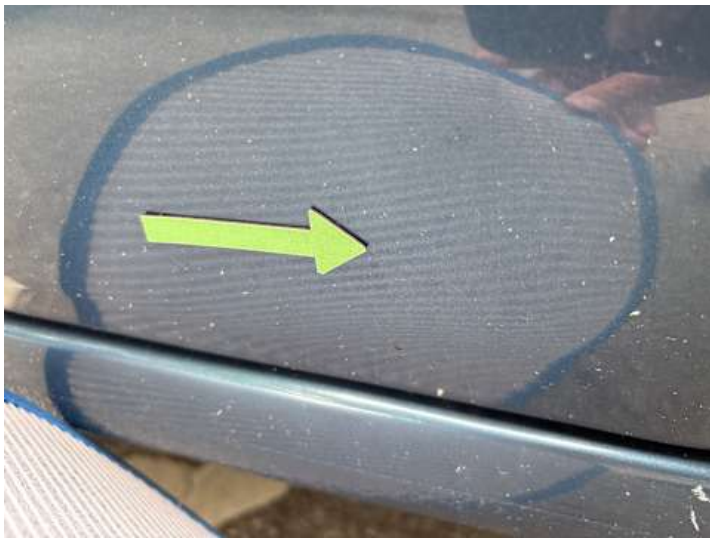
Türe hinten rechts (Kratzer, Delle)
