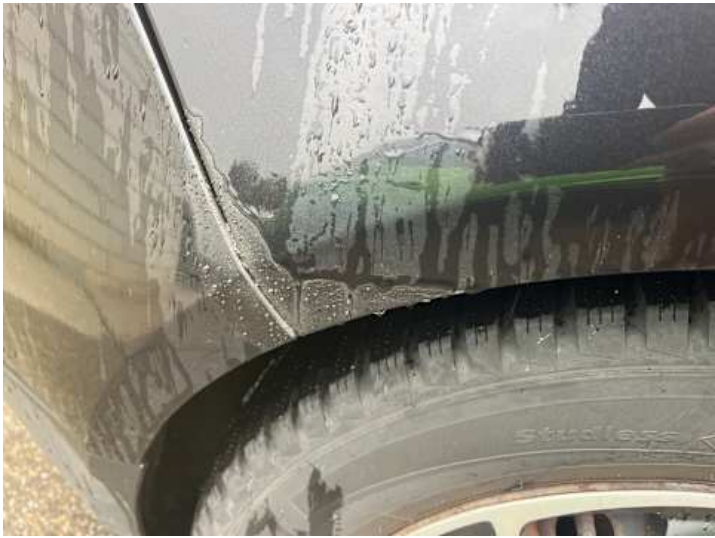
Seitenteil hinten rechts (Rost, Lackschaden)
