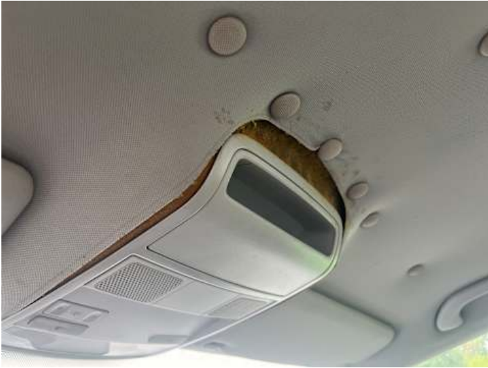
Innenraum (Anderer Schaden, Diverse Schäden): Dachhimmel hochgepinnt
