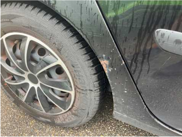
Seitenteil hinten rechts (Rost, Lackschaden)
