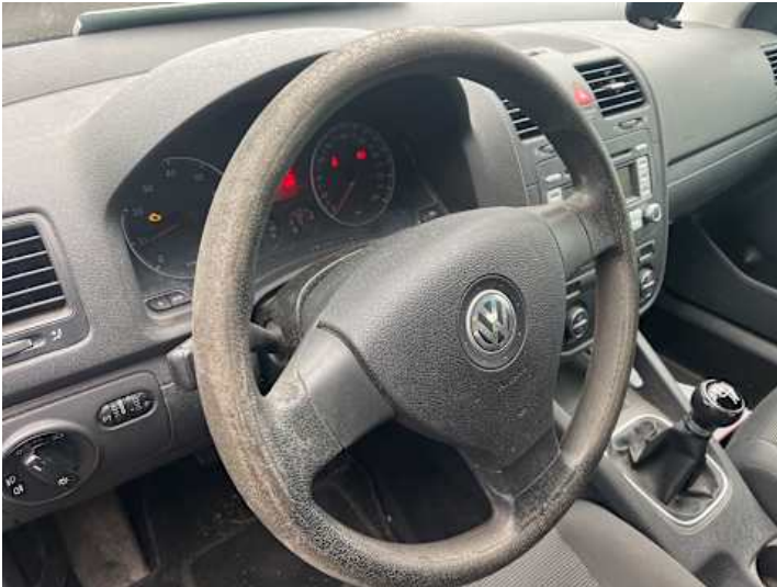
Innenraum (Verschmutzung, Verschleiß)
