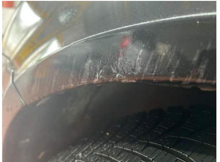
Kotflügel vorne links (Rost)
