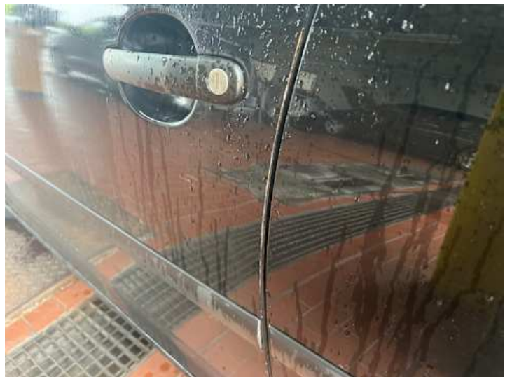
Fahrtür (Lackschaden, Rost)
