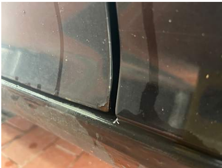
Fahrtür (Lackschaden, Rost)
