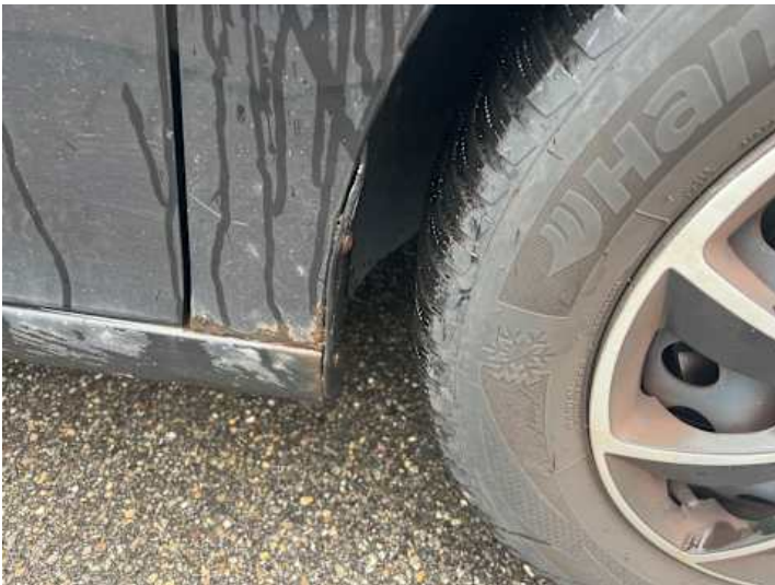
Kotflügel vorne rechts (Rost)
