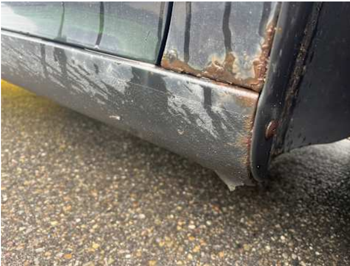
Schweller rechts (Rost)
