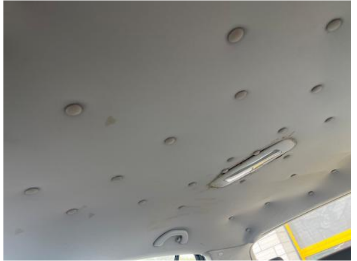
Innenraum (Anderer Schaden, Diverse Schäden): Dachhimmel hochgepinnt
