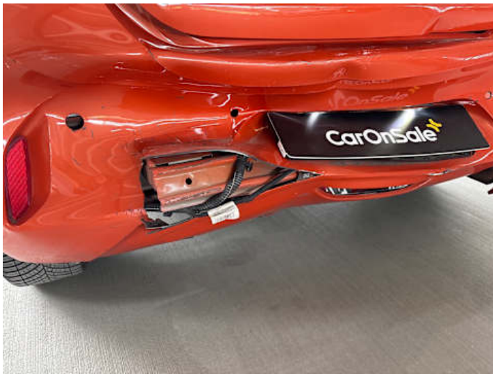
Stoßstange hinten (Verformung, Riss/Bruch)
