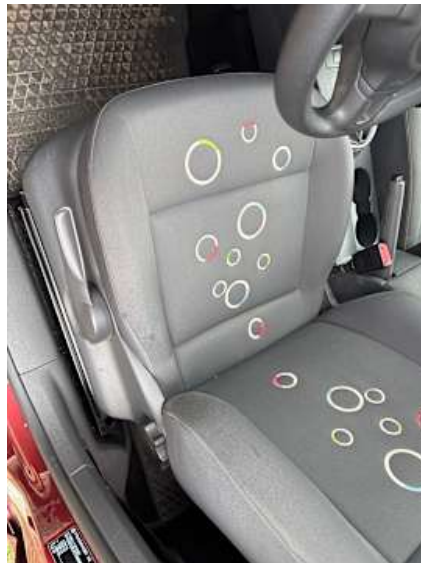
Innenraum (Verschmutzung, Kratzer)
