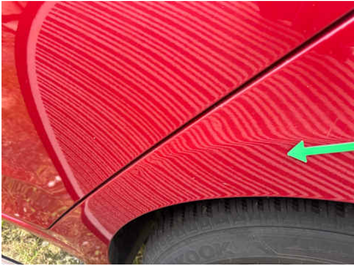
Seitenteil hinten links (Delle)
