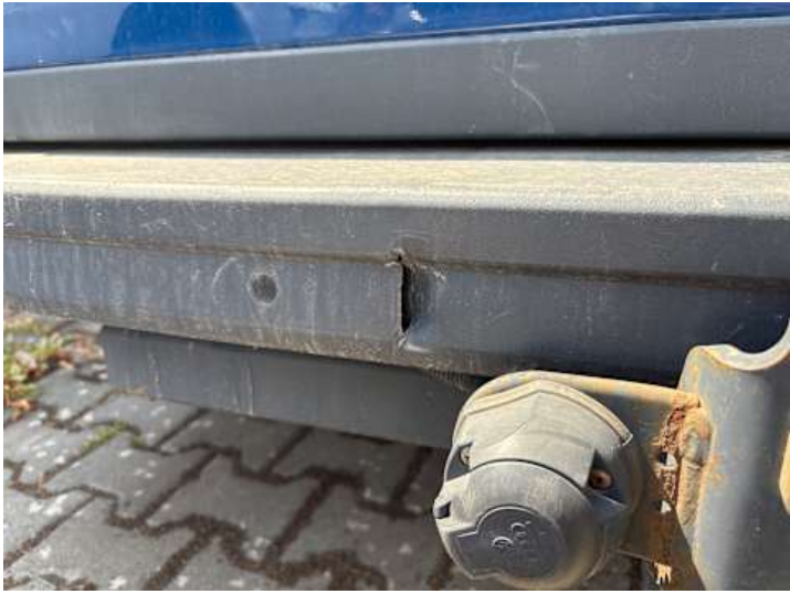
Stoßstange hinten (Riss/Bruch)
