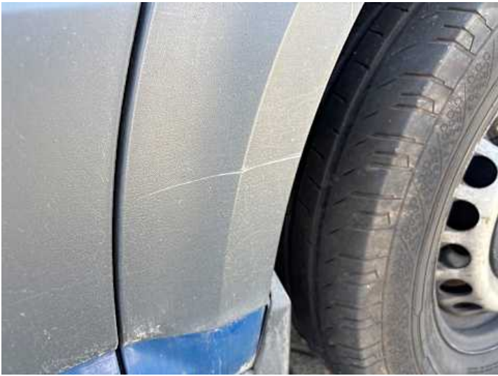
Kotflügel vorne rechts (Kratzer)
