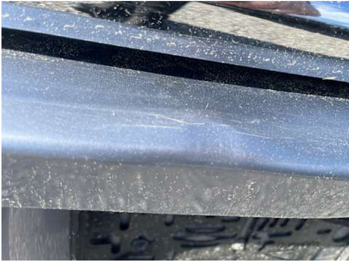
Stoßstange hinten (Riss/Bruch, Verformung)
