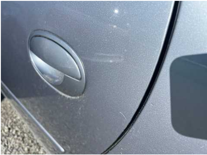
Türe hinten links (Lackschaden, Kratzer)
