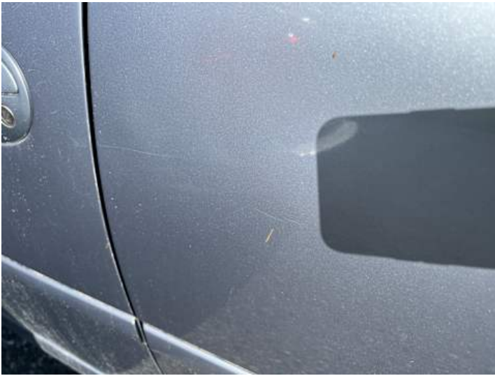
Türe hinten links (Lackschaden, Kratzer)
