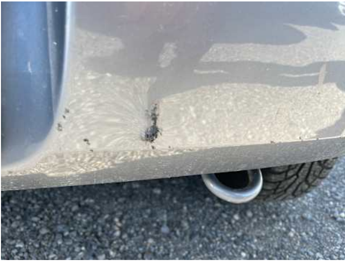
Stoßstange hinten (Riss/Bruch, Verformung)
