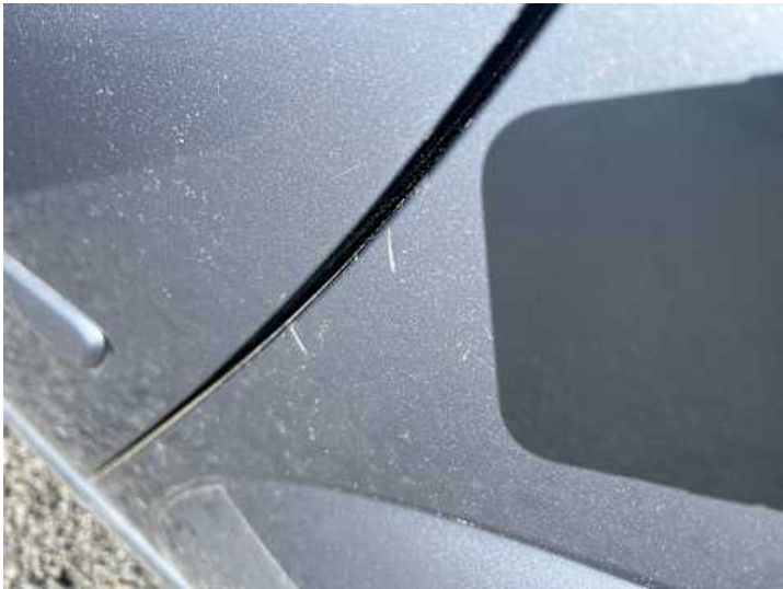
Seitenteil hinten links (Lackschaden)
