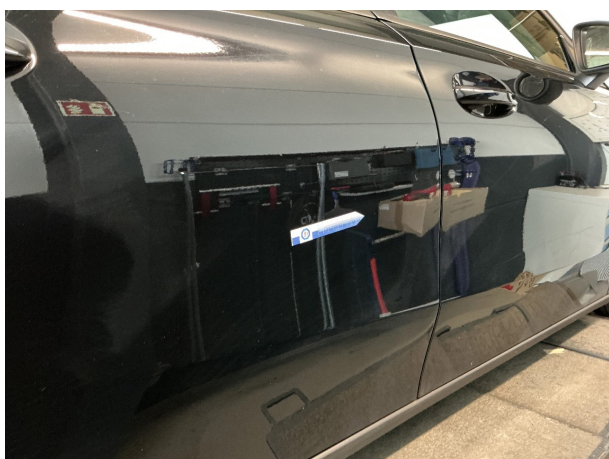
Beschädigung #6: Tür hinten rechts: Tür - Kratzer - lackieren
