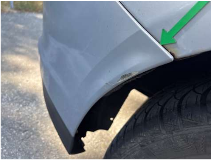
Stoßstange hinten (Kratzer, Verformung)
