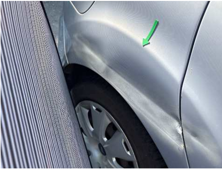
Seitenteil hinten rechts (Kratzer, Lackschaden, Unsachgemäß instand gesetzt, Verformung)
