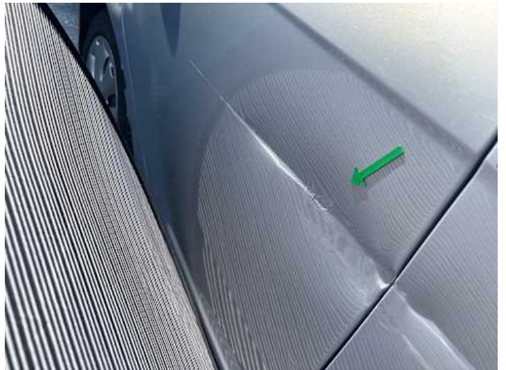
Türe hinten rechts (Kratzer, Verformung)
