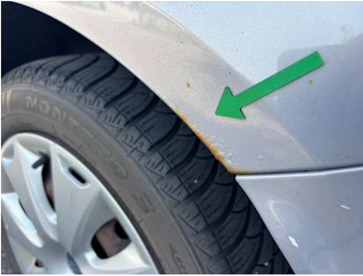
Seitenteil hinten links (Rost)
