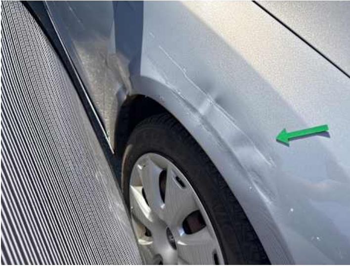
Kotflügel vorne rechts (Kratzer, Lackschaden, Verformung, Rost)
