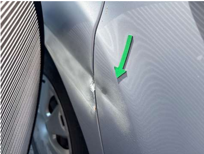
Türe hinten rechts (Verformung, Unsachgemäß instand gesetzt, Lackschaden)
