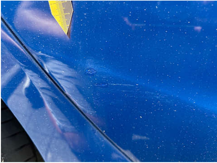
Türe hinten rechts (Unsachgemäß instand gesetzt)
