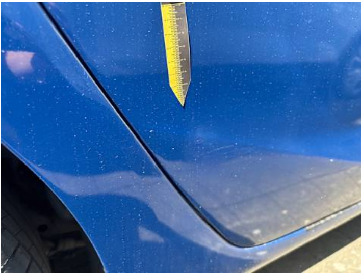
Türe hinten rechts (Unsachgemäß instand gesetzt)
