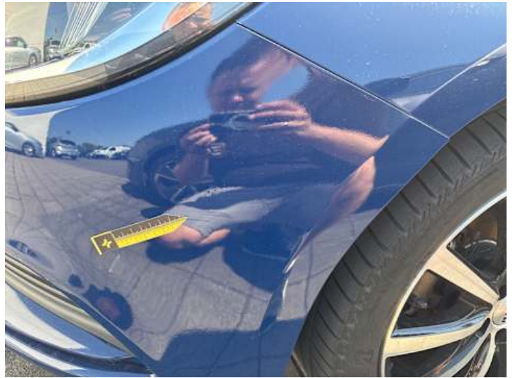
Stoßstange vorne (Unsachgemäß instand gesetzt)
