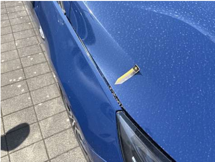
Kotflügel vorne rechts (Spaltmaße ungenau)
