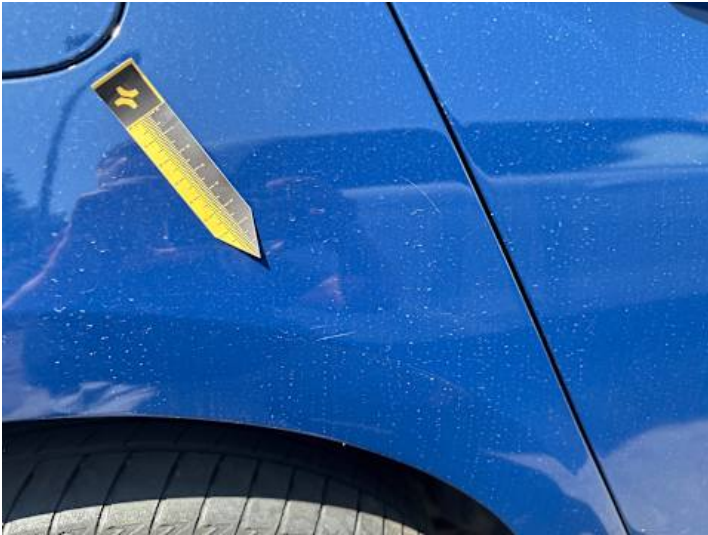
Seitenteil hinten rechts (Kratzer)
