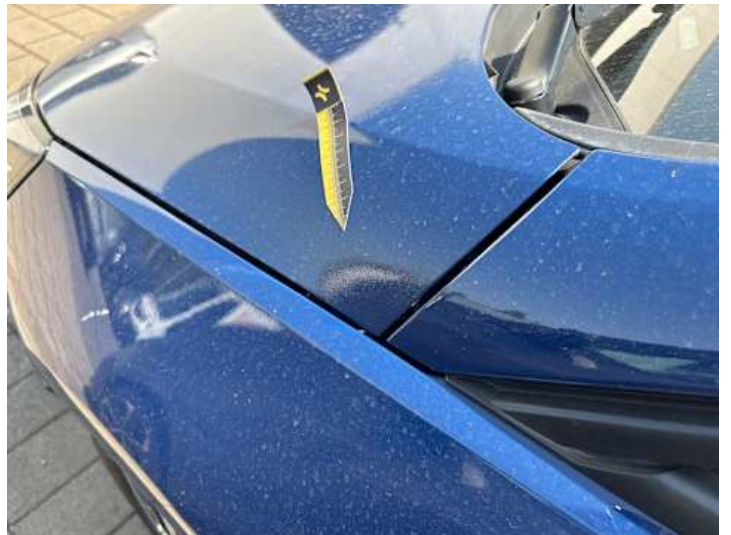
Motorhaube (Unsachgemäß instand gesetzt)
